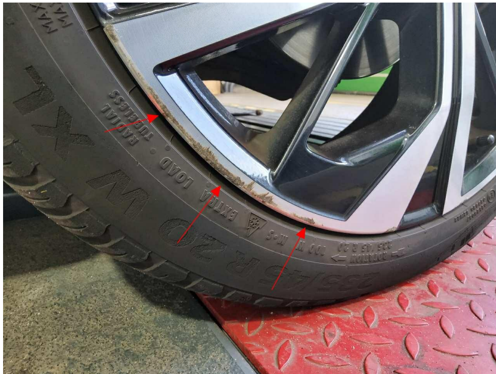
Bild 17 : LM-Felge vorne rechts verschrammt ( Glanzgedreht )
