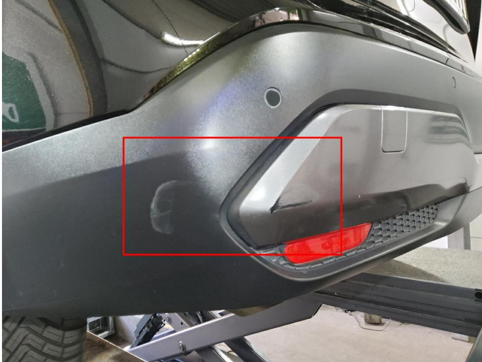
Bild 19 : Stoßfänger hinten verschrammt
