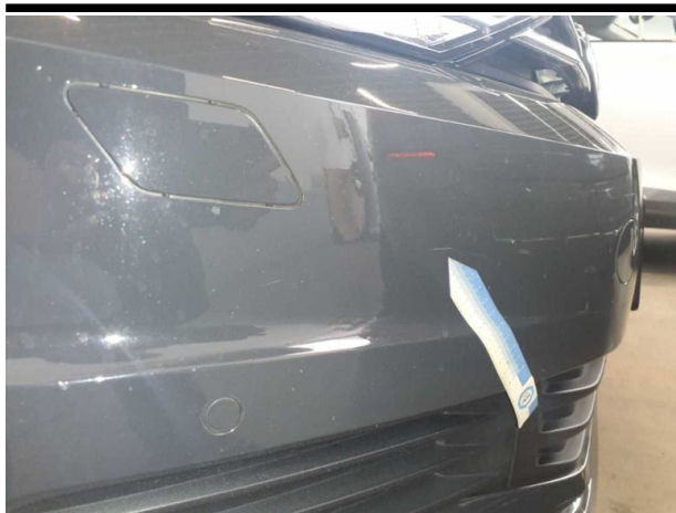
Beschädigung #5: Stossfänger vorn: Stossfänger vorn - Kratzer - lackieren
