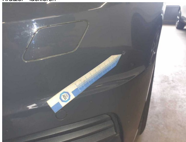
Beschädigung #5: Stossfänger vorn: Stossfänger vorn - Kratzer - lackieren
