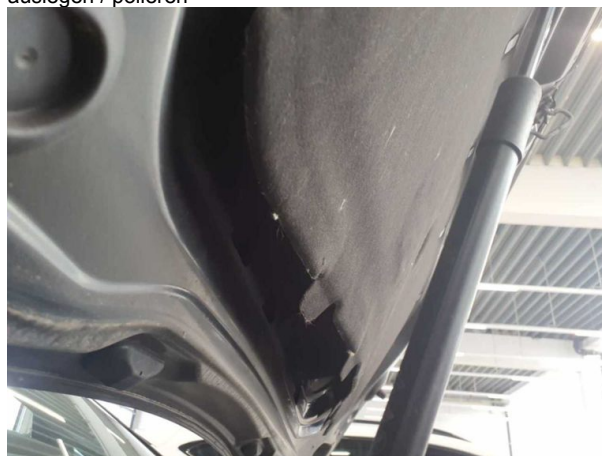
Beschädigung #2: Motorhaube: Dämmmatte - lose - de-/montieren
