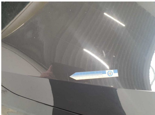
Beschädigung #1: Motorhaube: Motorhaube - Kratzer - auslegen / polieren
