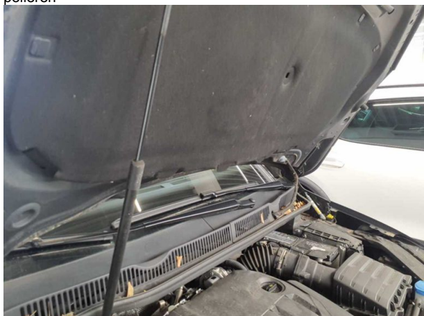
Beschädigung #2: Motorhaube: Dämmmatte - lose - de-/montieren
