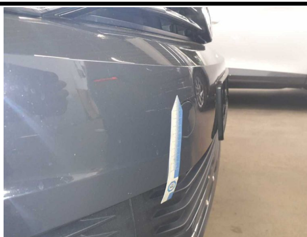
Beschädigung #5: Stossfänger vorn: Stossfänger vorn - Kratzer - lackieren
