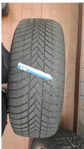
Damage 6: 2nd wheel set: 2 tyres (Einseitig Abgefahren) - Worn - Replace
