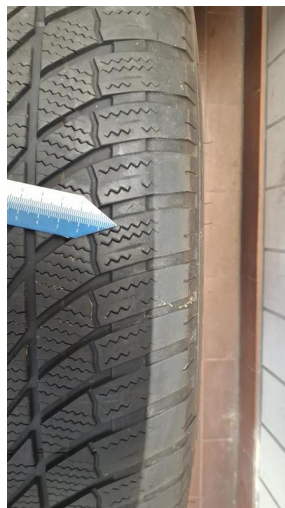
Damage 6: 2nd wheel set: 2 tyres (Einseitig Abgefahren) - Worn - Replace
