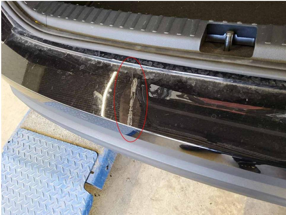
Bild 19 : Stoßfänger hinten, Lackierung, verschrammt
