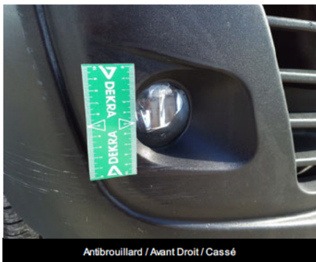
Antibrouillard / Avant Droit / Cassé
