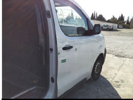
Porte / Avant Droit / Enfoncement
