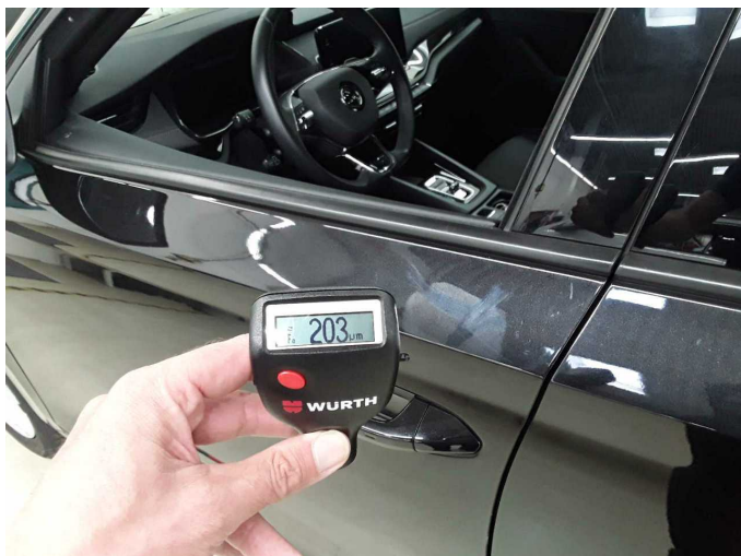
Door - front left side: 203 µm
