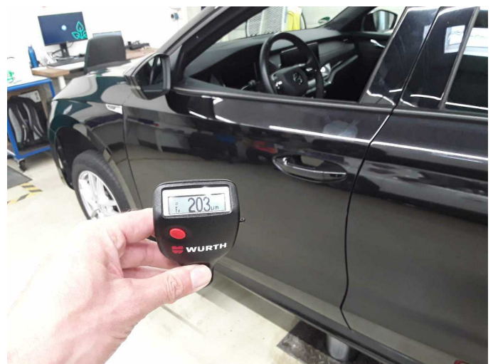
Door - front left side: 203 \mu\text{m}
