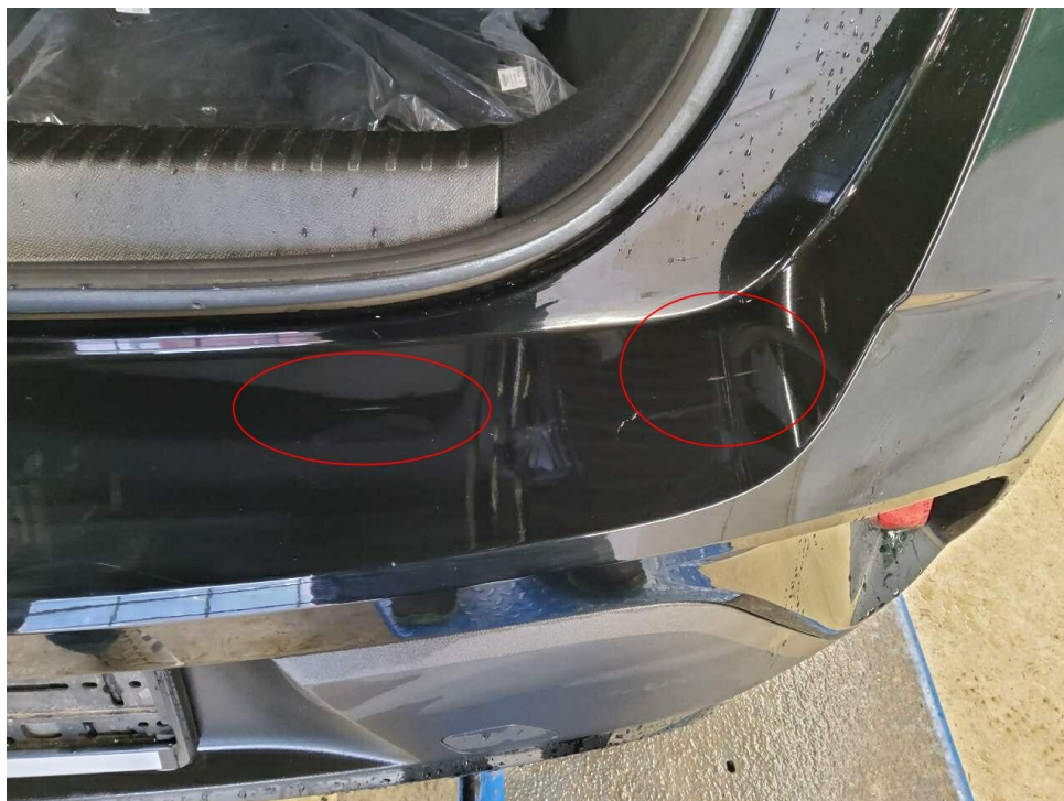
Bild 18 : Schaden Heckklappe durch Anstoß auf den Stoßfänger hinten
