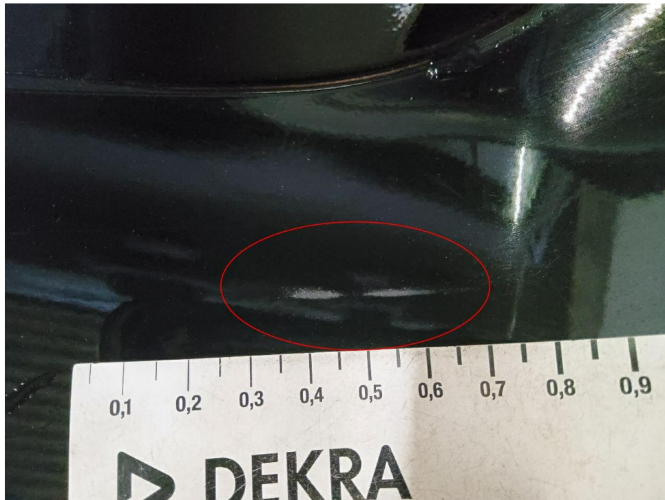
Bild 19 : Schaden Heckklappe durch Anstoß auf den Stoßfänger hinten
