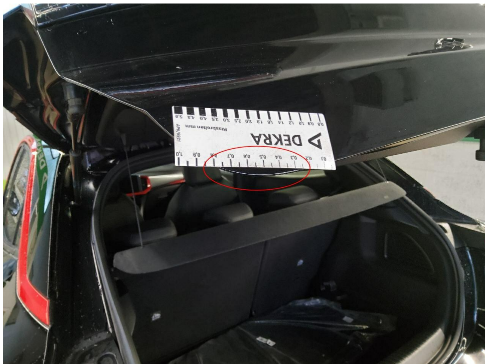
Bild 16 : Schaden Heckklappe durch Anstoß auf den Stoßfänger hinten
