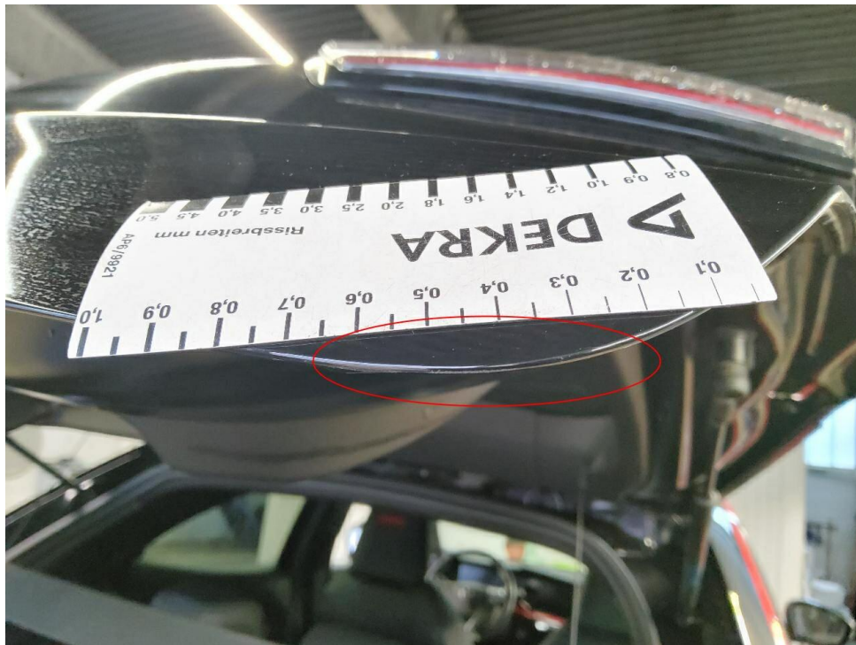
Bild 15 : Schaden Heckklappe durch Anstoß auf den Stoßfänger hinten
