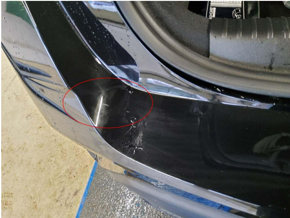
Bild 21 : Schaden Heckklappe durch Anstoß auf den Stoßfänger hinten
