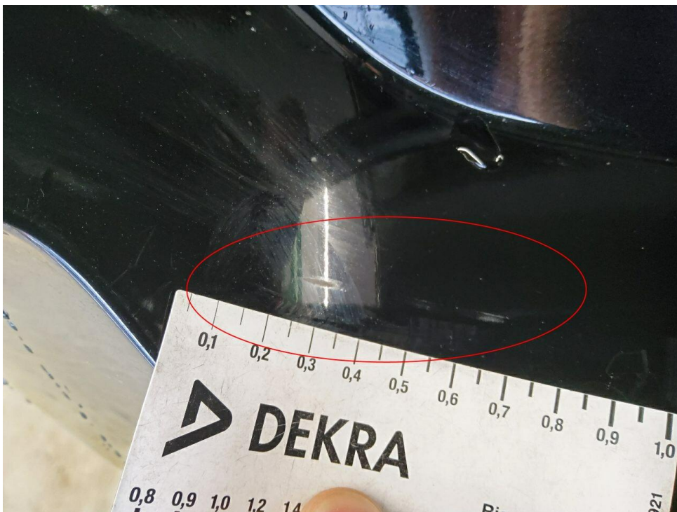
Bild 22 : Schaden Heckklappe durch Anstoß auf den Stoßfänger hinten
