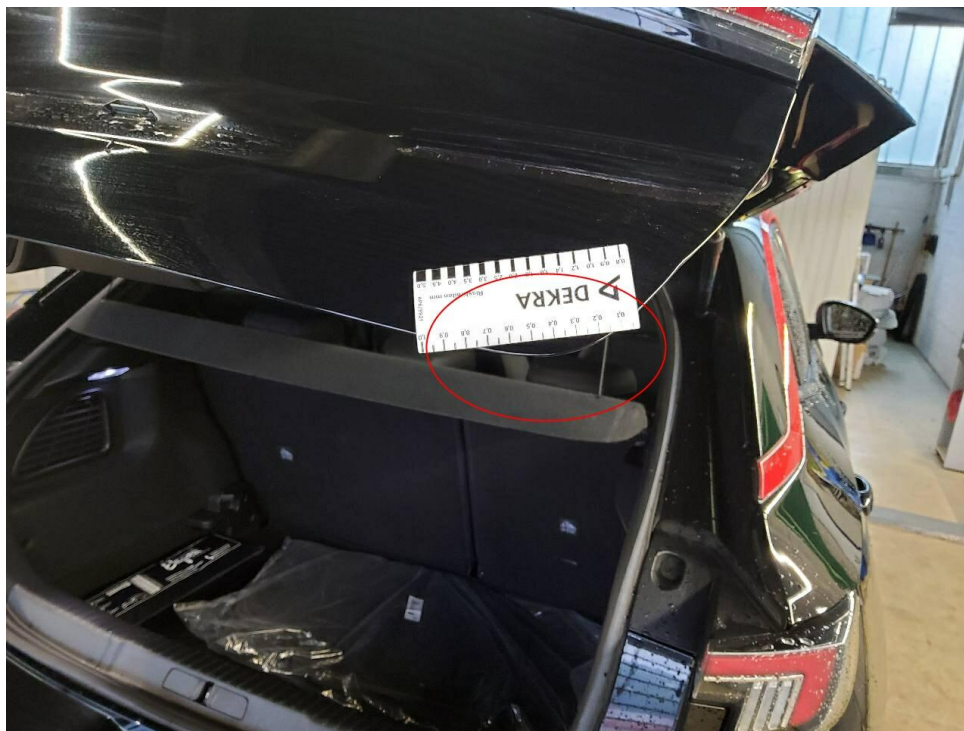
Bild 14 : Schaden Heckklappe durch Anstoß auf den Stoßfänger hinten
