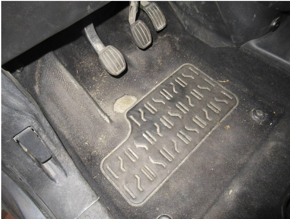
Bild 7 : Innenraum Bodenbelag vorne links verschlissen
