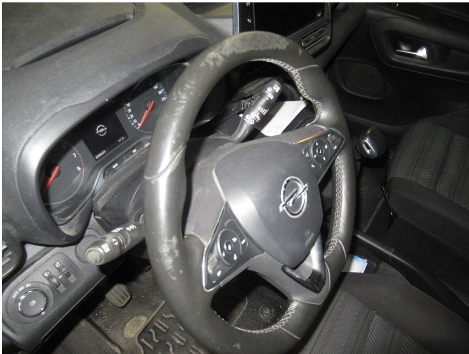
Bild 6 : Innenraum Lenkradbezug verschlissen
