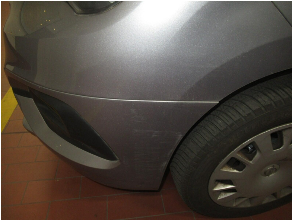
Bild 13 : Stoßfänger vorne verschrammt
