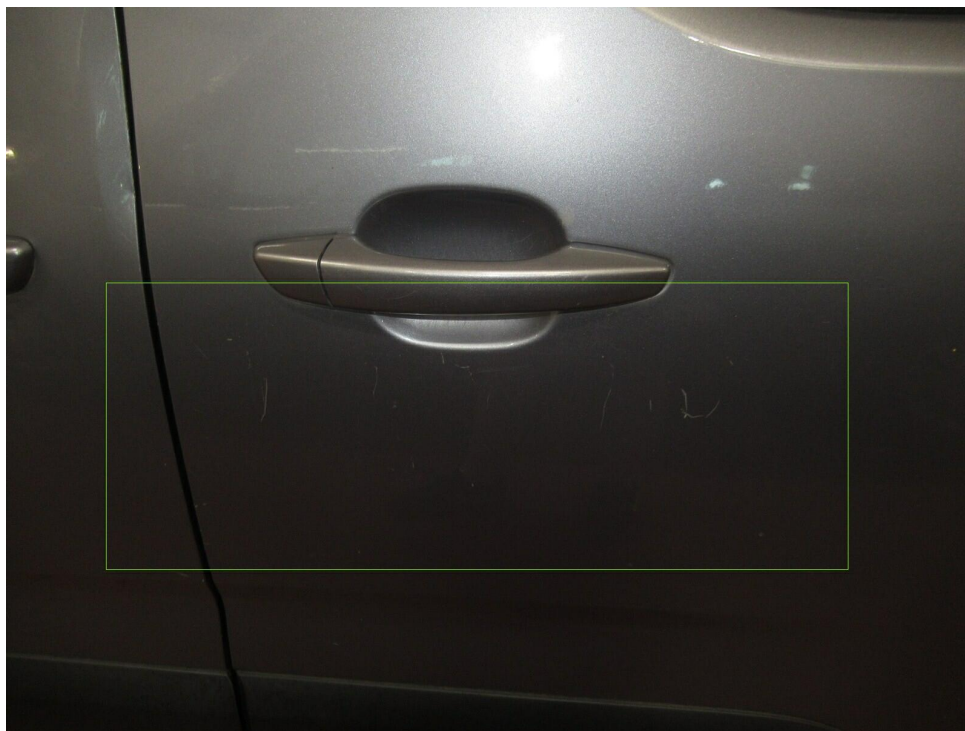
Bild 12 : Tür hinten links zerkratzt
