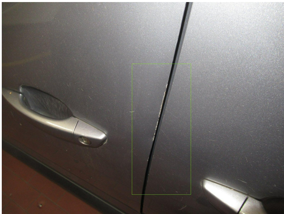
Bild 9 : Tür vorne links Kantenbereich verformt, abgeknickt
