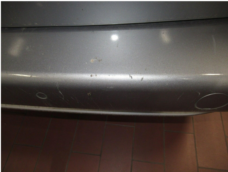
Bild 16 : Stoßfänger hinten zerkratzt, eingekerbt
