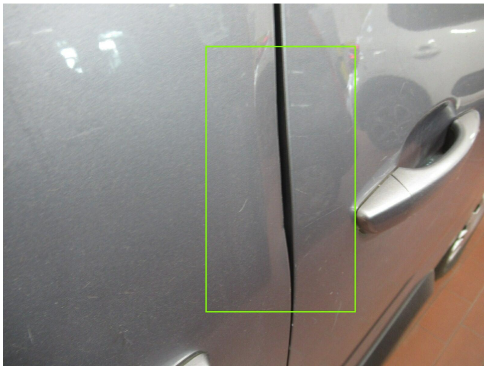
Bild 11 : Tür vorne links Kantenbereich verformt, abgeknickt
