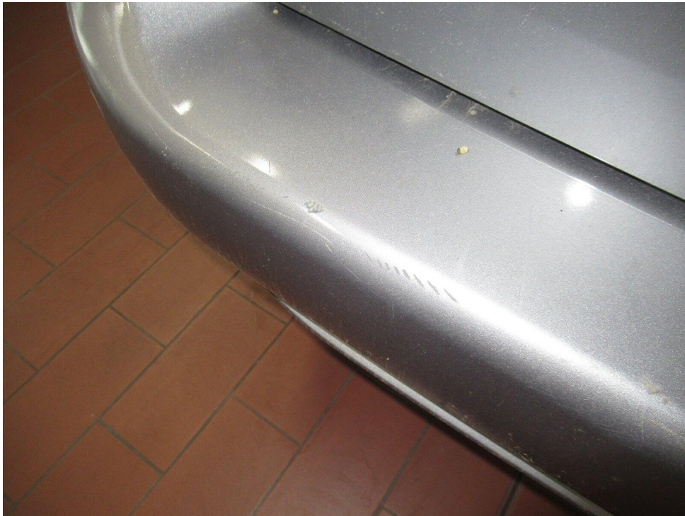
Bild 15 : Stoßfänger hinten zerkratzt, eingekerbt
