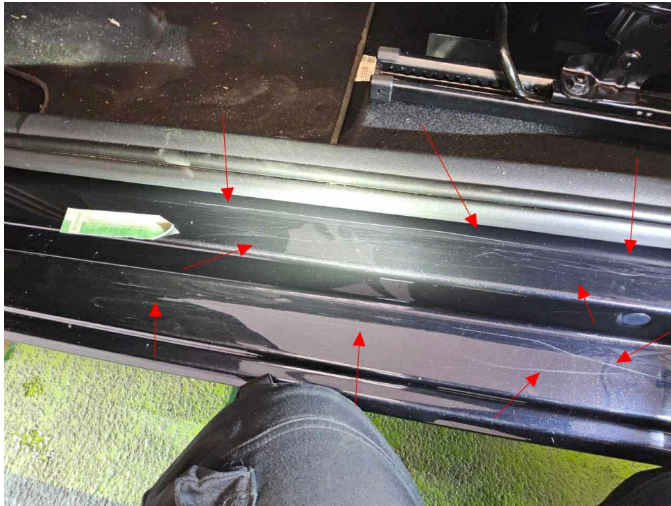
Bild 19 : Tür vorne links Einstieg Lackierung, zerkratzt, smart repair
