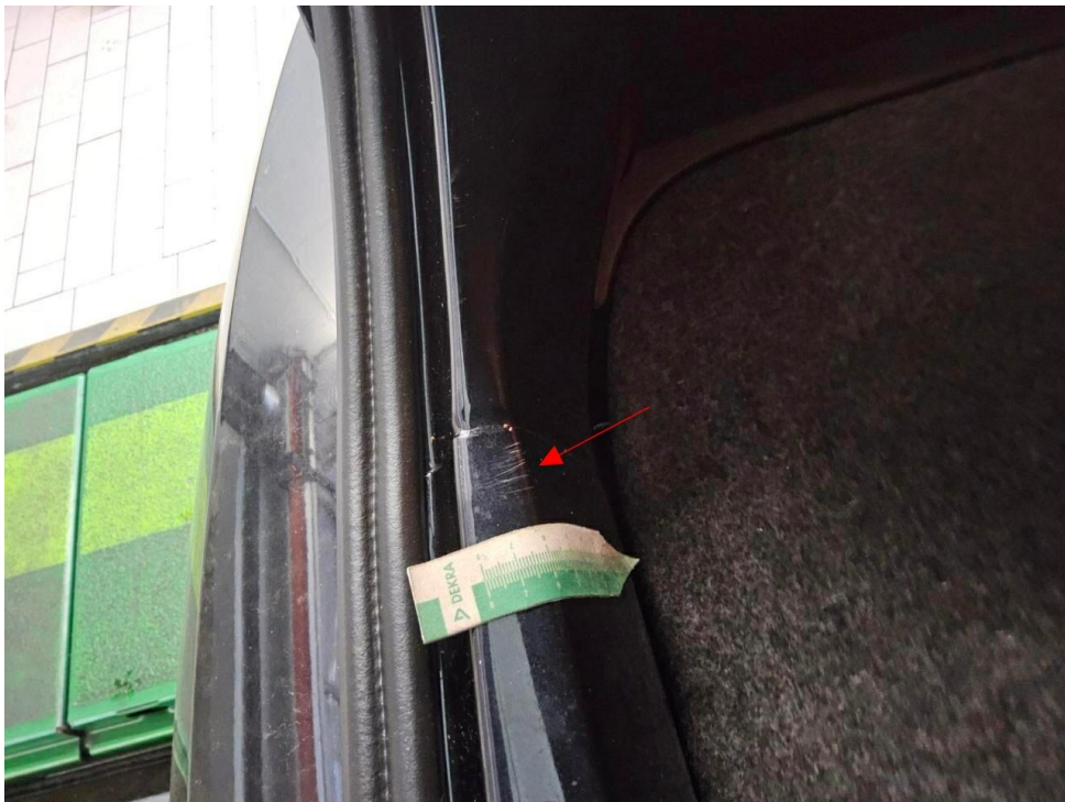
Bild 24 : Ladekantenabdeckung, verschrammt, Gebrauchsspur
