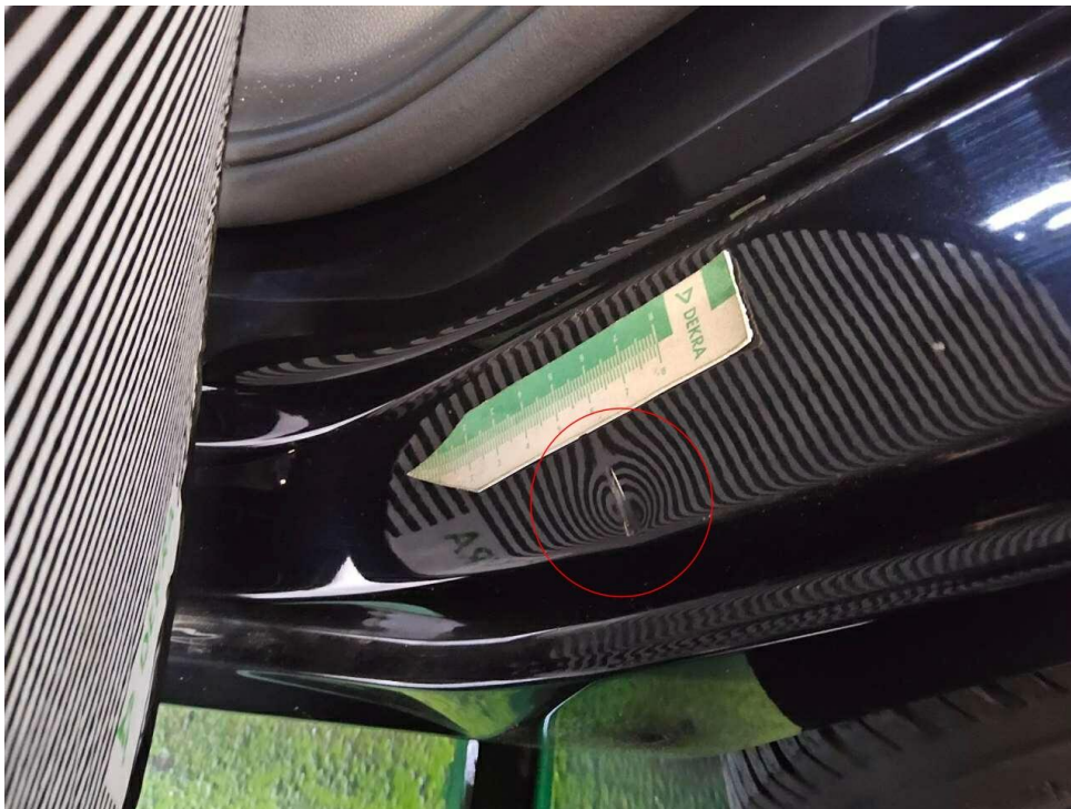
Bild 18 : Tür hinten links Einstieg, eingedellt, instandsetzen und lackieren mit Lackaufbau
