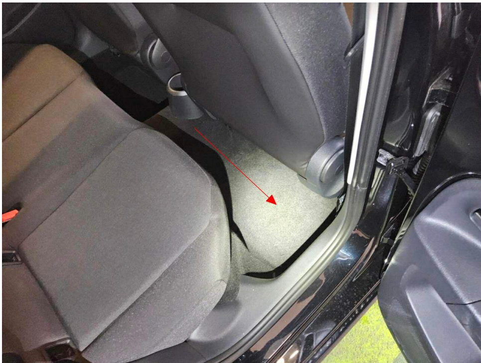
Bild 16 : Bodenbelag hinten Fußmatte rechts, fehlt, erneuern
