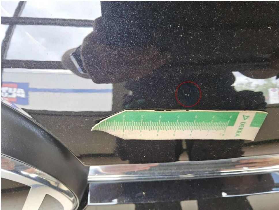
Bild 27 : Motorhaube Lackierung, Steinschlag, Gebrauchsspur
