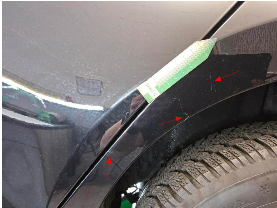
Bild 21 : Seitenteil hinten links Lackierung unterhalb, verschrammt, Gebrauchsspur
