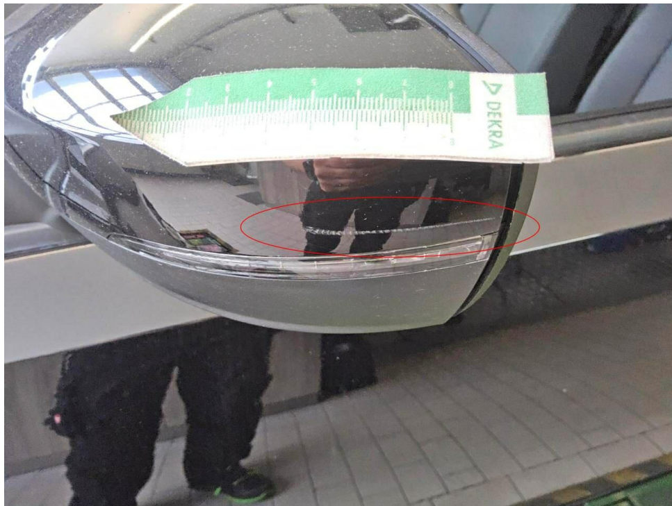
Bild 25 : Außenspiegel links Lackierung, verschrammt, Gebrauchsspur
