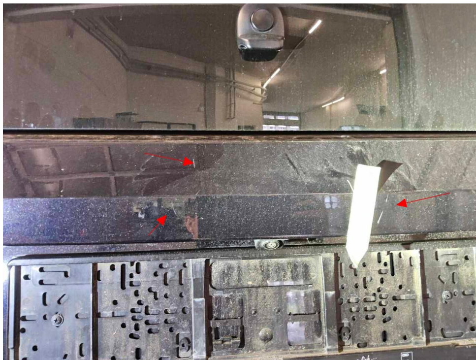
Bild 20 : Stoßfänger hinten Lackierung, verschrammt, Gebrauchsspur
