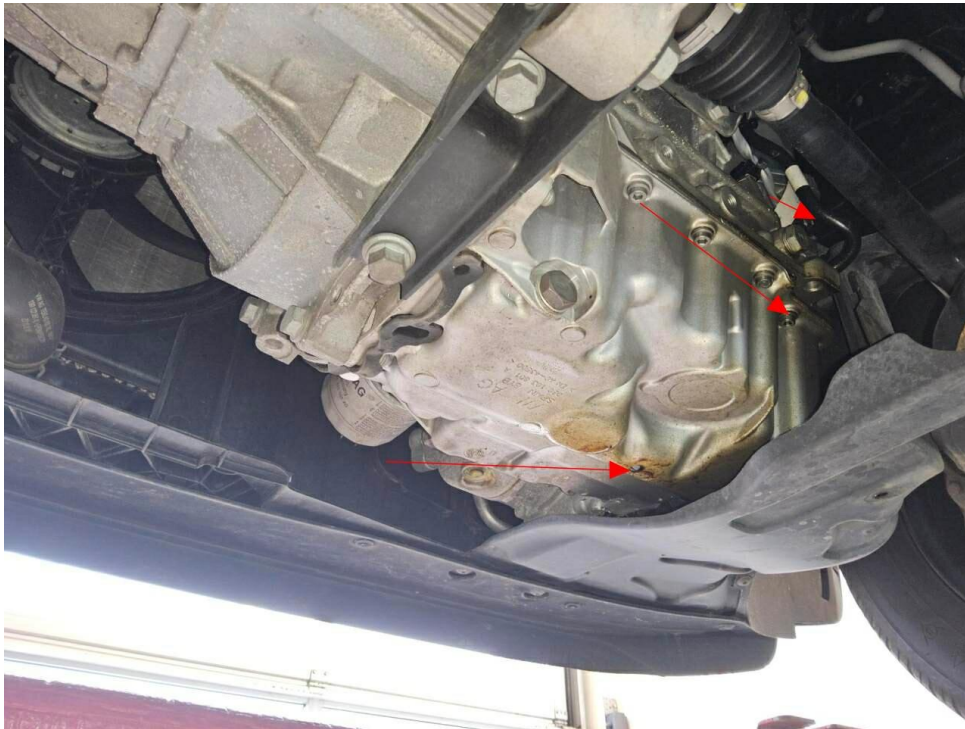
Bild 15 : Motor, undicht, prüfen und Befund festlegen, Schadenerweiterung möglich
