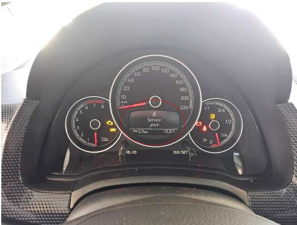
Bild 14 : Service/Inspektion Inspektion groß, überfällig, durchführen
