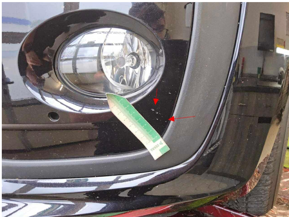
Bild 22 : Stoßfänger vorne Lackierung, Steinschlag, Gebrauchsspur
