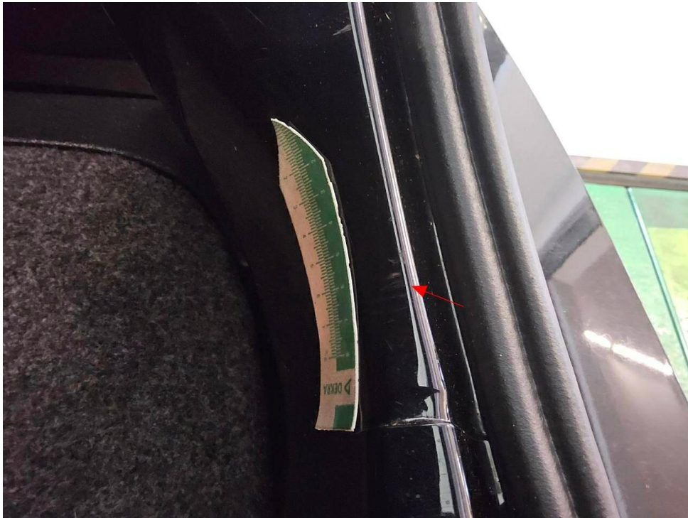
Bild 23 : Ladekantenabdeckung, verschrammt, Gebrauchsspur
