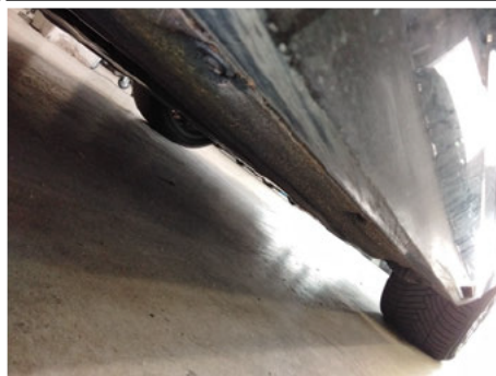
Schwellerverkleidung / Rechts / Kratzer
