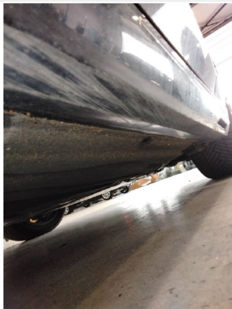
Schwellerverkleidung / Rechts / Kratzer
