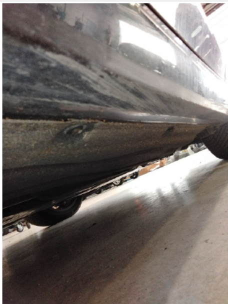
Schwellerverkleidung / Rechts / Kratzer
