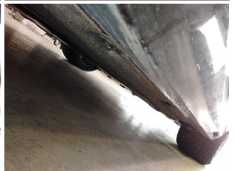
Schwellerverkleidung / Rechts / Kratzer
