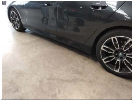
Schwellerverkleidung / Links / Kratzer
