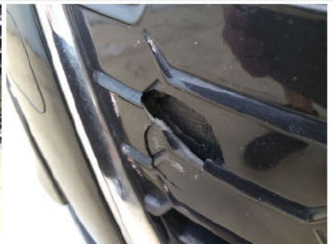
Pralldämpfer Stoßfänger / Vorne / Gebrochen
