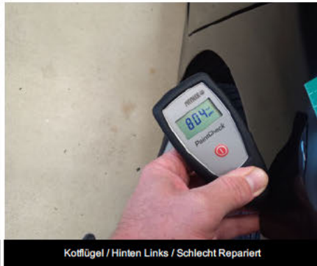
Kotflügel / Hinten Links / Schlecht Repariert
