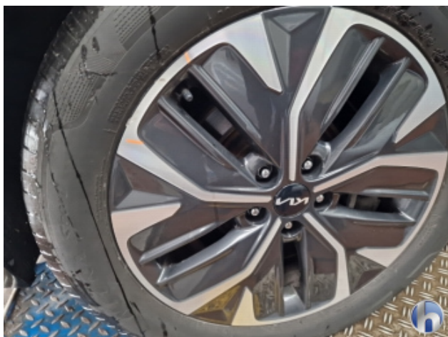
1. Felge Hinten - Rechts Beschädigt - Smart Repair
