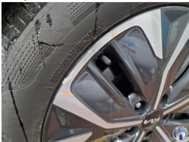
1. Felge Hinten - Rechts Beschädigt - Smart Repair
