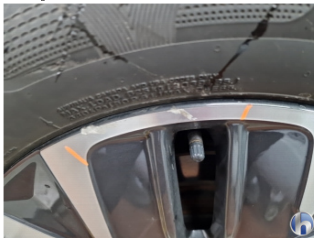
1. Felge Hinten - Rechts Beschädigt - Smart Repair
