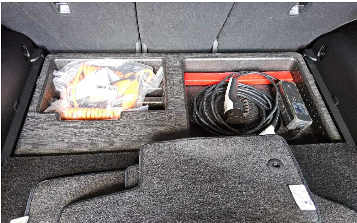
Bild 6 : Ladekabel beim E-Fahrzeug
