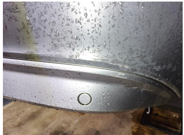
Bild 12: Außen, Heckschürze hinten unten, verschrammt, ersetzen
