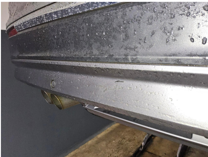
Bild 11: Außen, Heckschürze hinten unten, verschrammt, ersetzen
