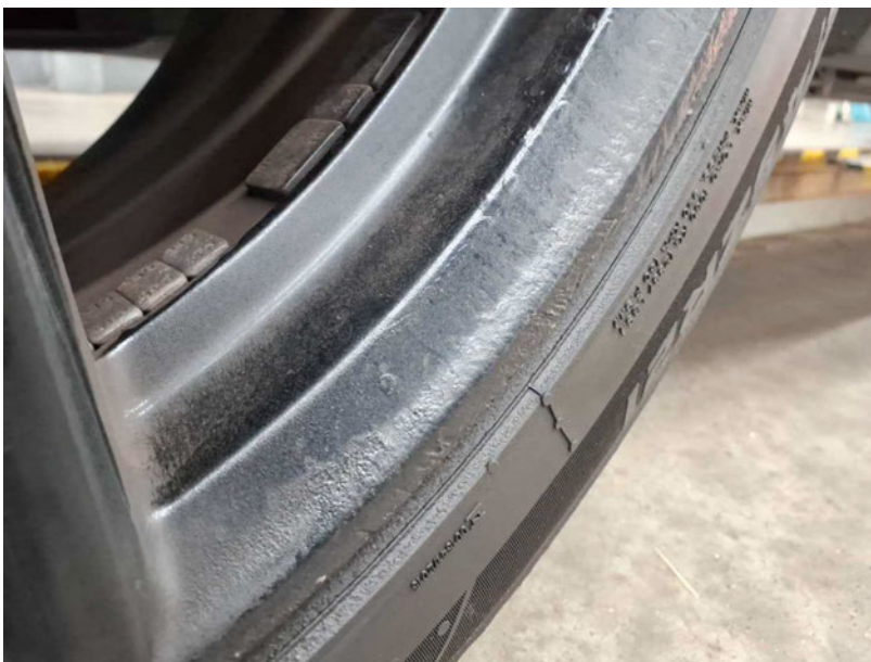
Beschädigung #35: Rad/Reifen: Felgensatz komplett (+ Lackmängel) - verkratzt / verschürft - erneuern
