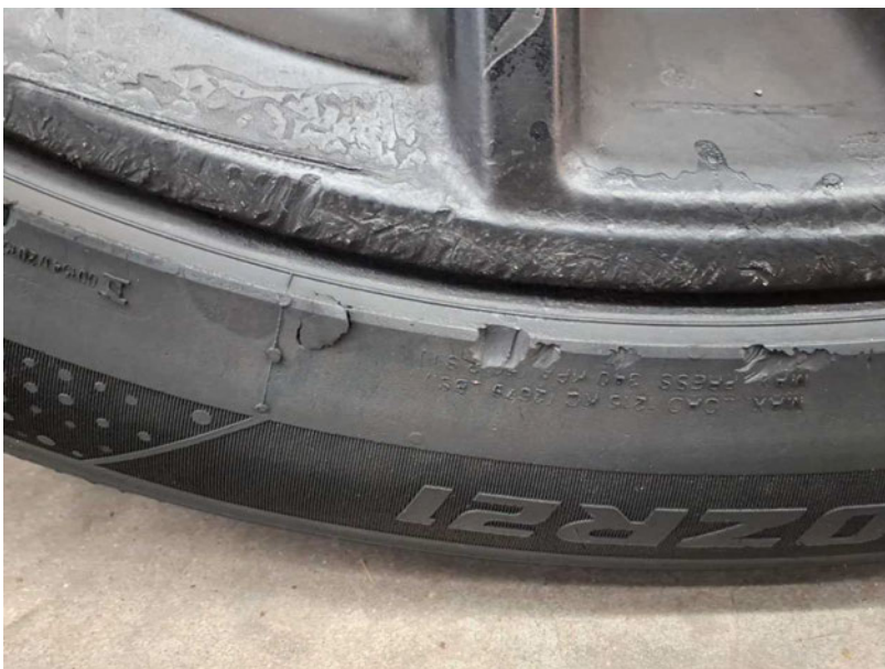
Beschädigung #12: Rad/Reifen: Reifen hinten links - beschädigt - erneuern
