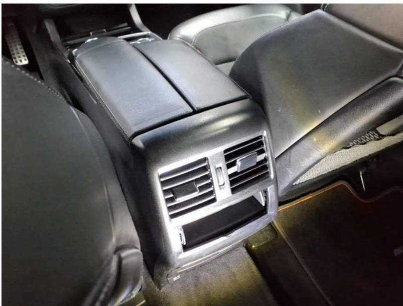
Beschädigung #10: Instrumententafel: Mittelkonsole hinten (+ Luftdüse rechts) - gebrochen / gerissen - erneuern
