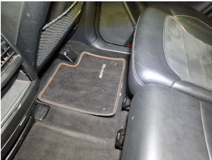
Beschädigung #5: Verkleidungen/Abdeckungen: Fußmatten - beschädigt - erneuern
