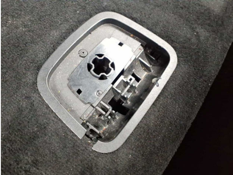
Beschädigung #1: Interieur: Laderaumboden (Griff) - gebrochen / gerissen - erneuern
