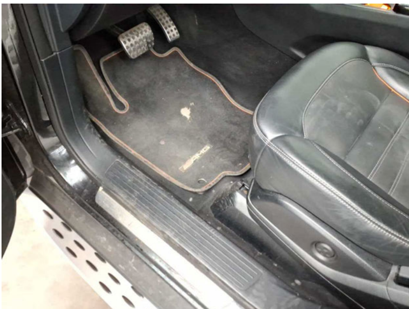
Beschädigung #33: Verkleidungen/Abdeckungen: Teppichboden - Brandloch - erneuern
