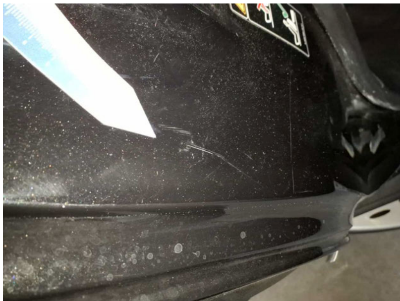
Beschädigung #16: Seitenwand rechts: Einstieg - Kratzer - lackieren
