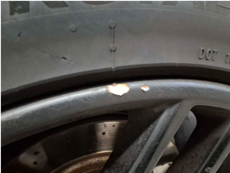
Beschädigung #35: Rad/Reifen: Felgensatz komplett (+ Lackmängel) - verkratzt / verschürft - erneuern
