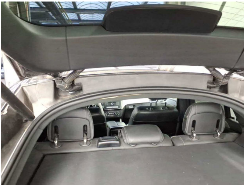
Beschädigung #2: Verkleidungen/Abdeckungen: Dachhimmel - lose - instandsetzen
