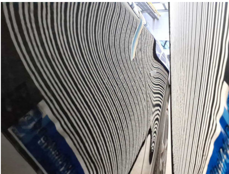
Beschädigung #30: Tür vorn rechts: Tür (wellig) - nicht fachgerecht instandgesetzt - instandsetzen und lackieren
