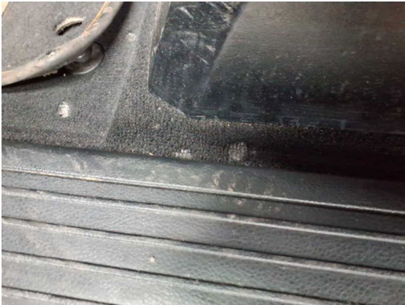
Beschädigung #33: Verkleidungen/Abdeckungen: Teppichboden - Brandloch - erneuern
