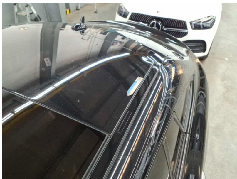
Beschädigung #6: Fahrzeugdach: Dach - Delle(n) - Smart Repair
