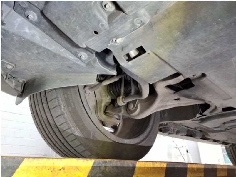
Beschädigung #17: Antriebsstrang: Manschette Gelenkwelle vorn rechts (aussen) - gebrochen / gerissen - erneuern
