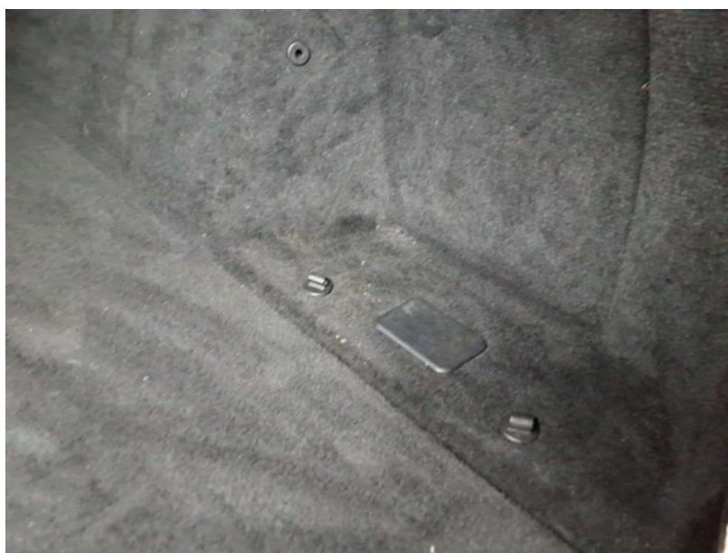
Fehlteil #4: Interieur: Gepäcknetz (Kofferraum rechts) - fehlt - erneuern
