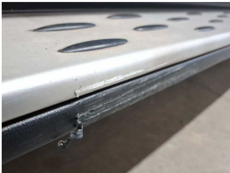
Beschädigung #25: Schweller rechts: Trittbrett - verkratzt / verschürft - erneuern
