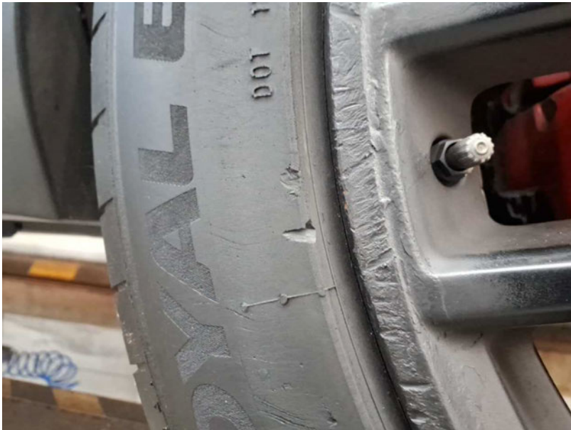
Beschädigung #12: Rad/Reifen: Reifen hinten links - beschädigt - erneuern
