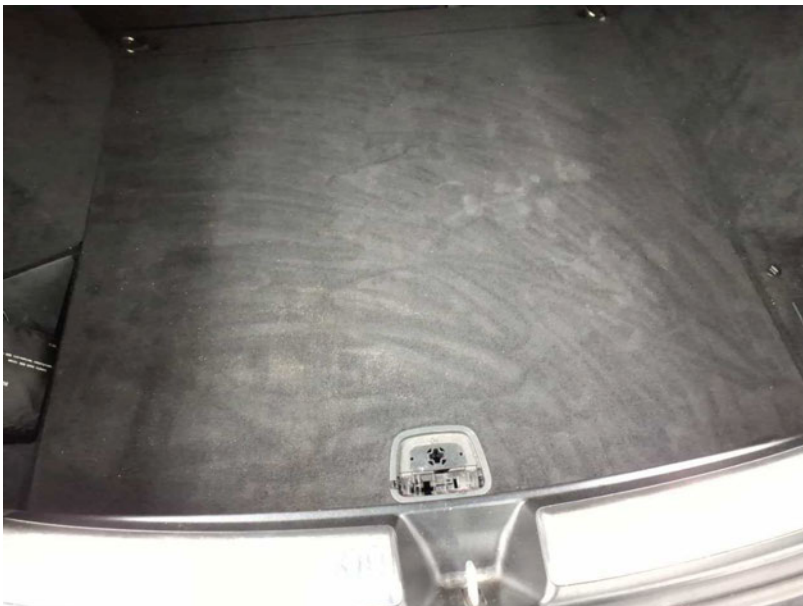
Beschädigung #1: Interieur: Laderaumboden (Griff) - gebrochen / gerissen - erneuern
