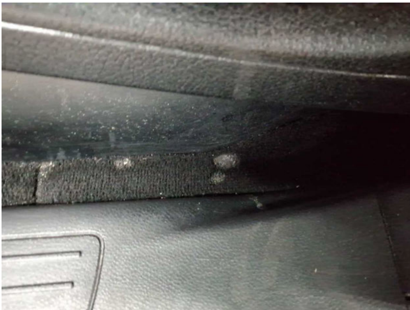
Beschädigung #33: Verkleidungen/Abdeckungen: Teppichboden - Brandloch - erneuern
