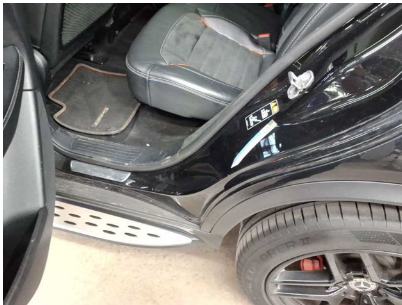
Beschädigung #15: Seitenwand links: Einstieg - Kratzer - lackieren
