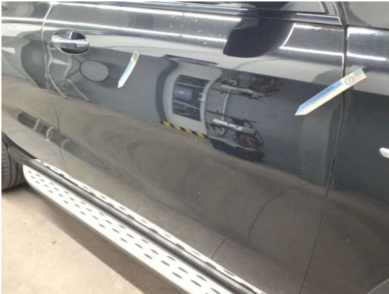
Beschädigung #30: Tür vorn rechts: Tür (wellig) - nicht fachgerecht instandgesetzt - instandsetzen und lackieren
