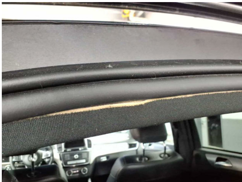
Beschädigung #2: Verkleidungen/Abdeckungen: Dachhimmel - lose - instandsetzen
