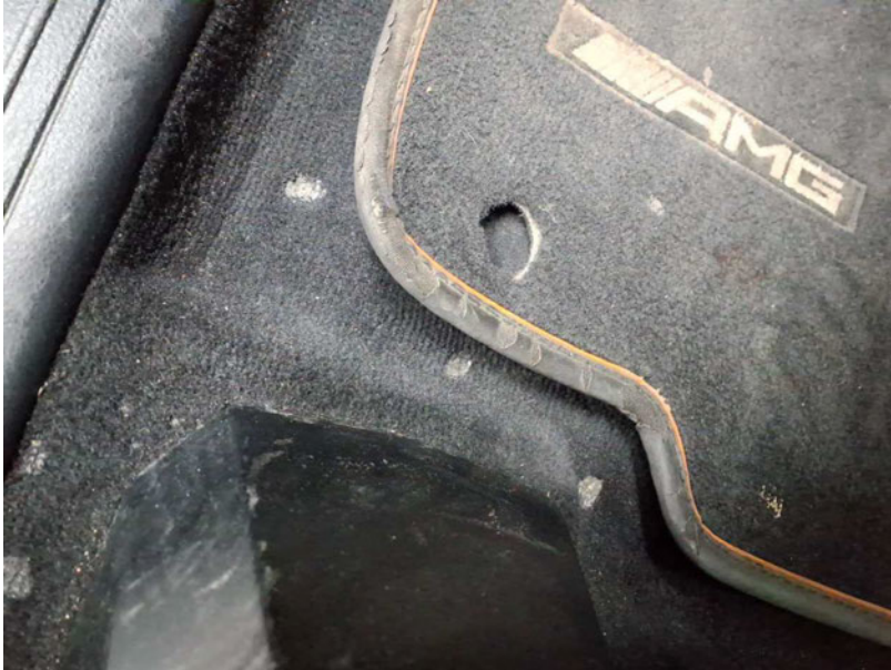
Beschädigung #33: Verkleidungen/Abdeckungen: Teppichboden - Brandloch - erneuern
