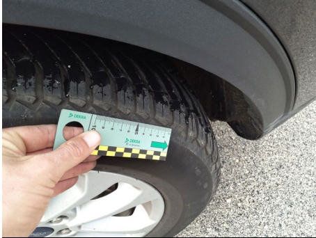
Pneumatico / Posteriore Sinistro / Usurato
