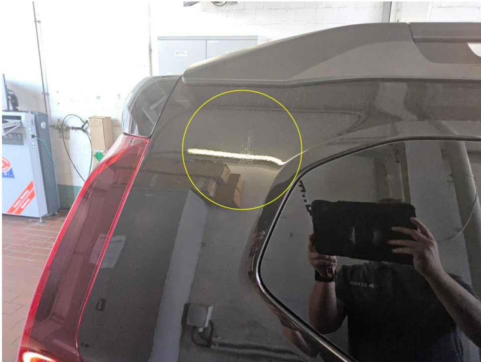
Bild 17 : Seitenteil hinten rechts Lackierung, Umweltschaden, lackieren mit Lackaufbau
