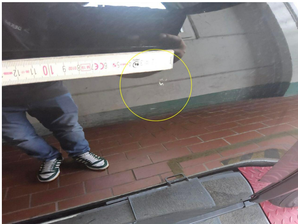
Bild 16 : Tür vorne rechts Lackierung, Umweltschaden, lackieren mit Lackaufbau
