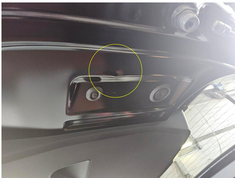
Bild 14 : Heckklappe, eingedellt, drücken
