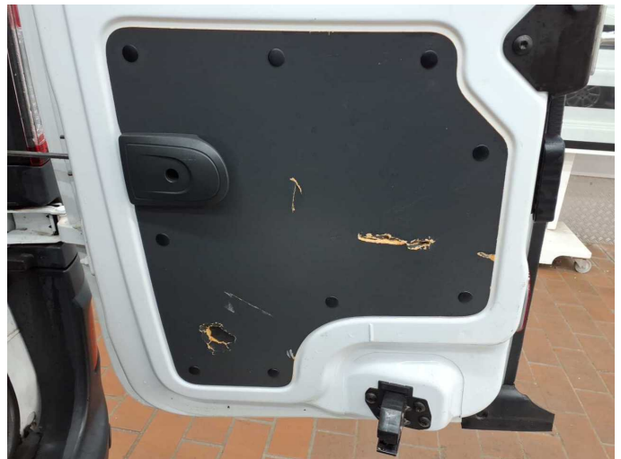
Damage 5: Interior: Interior (Verkleidungen) - Broken / torn - Replace
