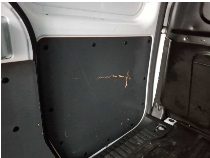
Damage 5: Interior: Interior (Verkleidungen) - Broken / torn - Replace
