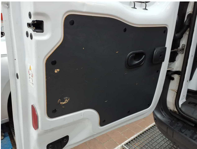
Damage 5: Interior: Interior (Verkleidungen) - Broken / torn - Replace
