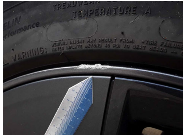
Beschädigung #4: Rad/Reifen: Leichtmetallfelge vorn links - verkratzt / verschürft - erneuern
