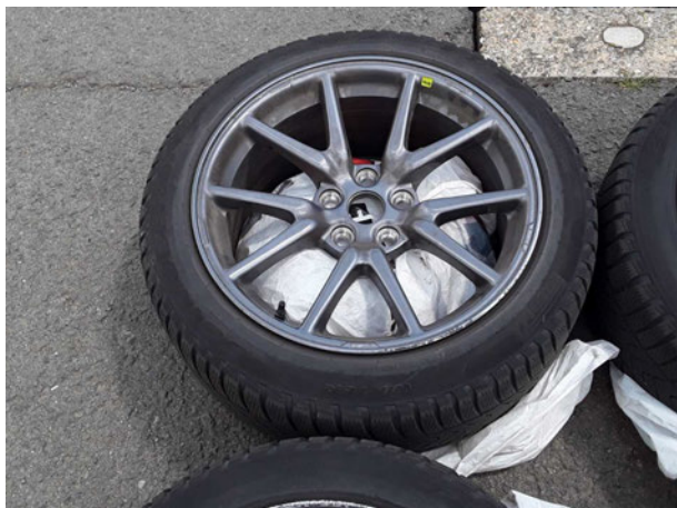
Beschädigung #1: 2.Radsatz: 1 Leichtmetallfelge - verkratzt / verschürft - Wertminderung
