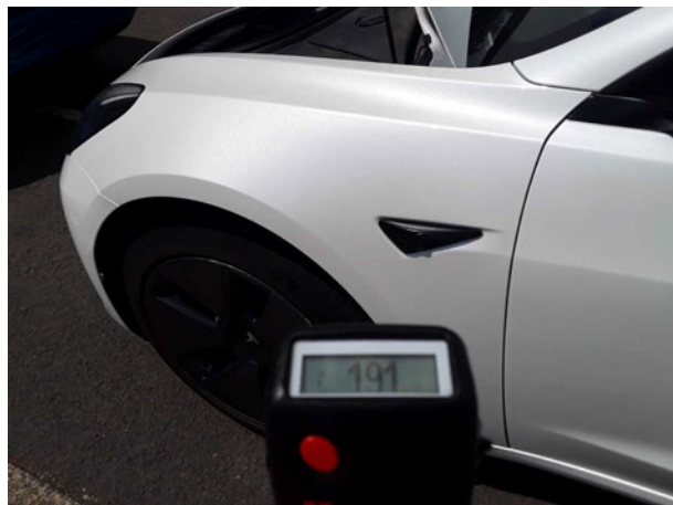
Nachlackierung 1: Heckklappe/-tür, Kotflügel links, Seitenwand links
