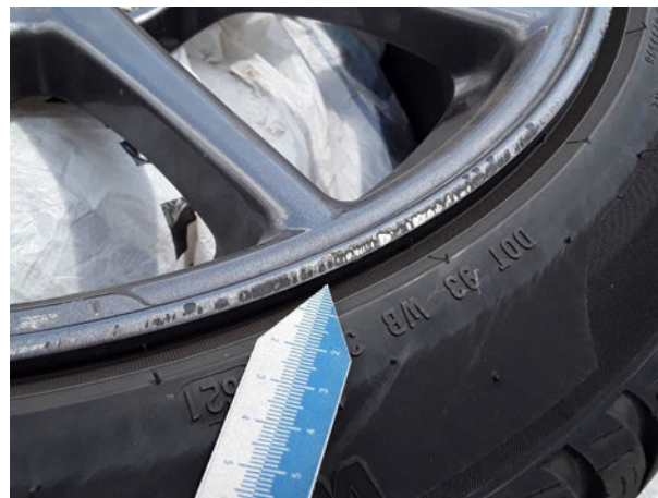
Beschädigung #1: 2.Radsatz: 1 Leichtmetallfelge - verkratzt / verschürft - Wertminderung
