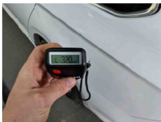
Lackstärke Seitenwand hinten links
