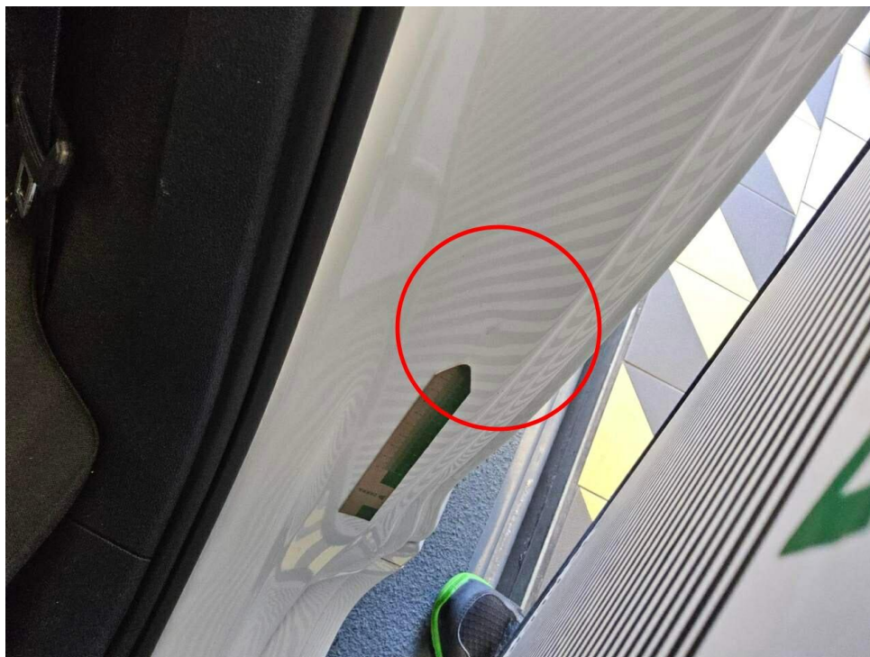
Bild 15 : Tür hinten links Einstieg, eingedellt, drücken
