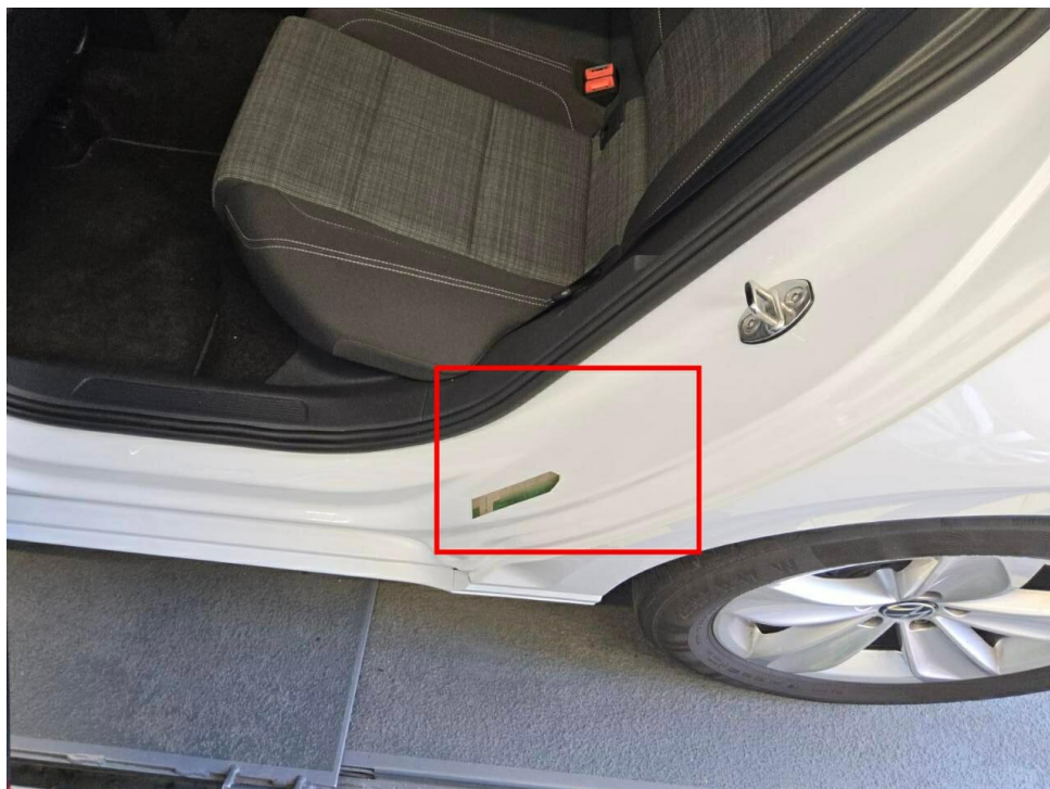
Bild 14 : Tür hinten links Einstieg, eingedellt, drücken
