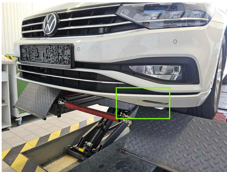
Bild 20 : Frontspoiler Lackierung, zerkratzt, Gebrauchsspur
