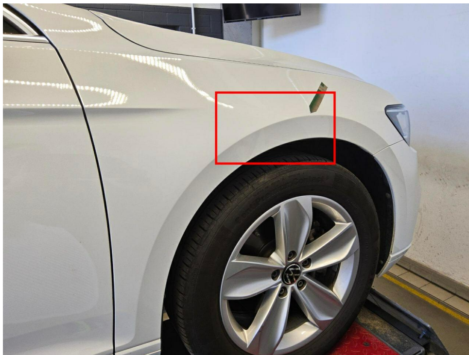
Bild 18 : Kotflügel vorne rechts, eingedellt, smart repair
