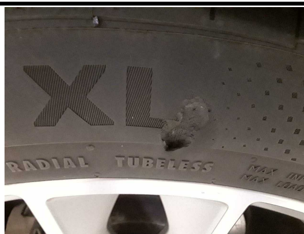
Beschädigung #6: Rad/Reifen: Reifen hinten links - gebrochen / gerissen - erneuern
