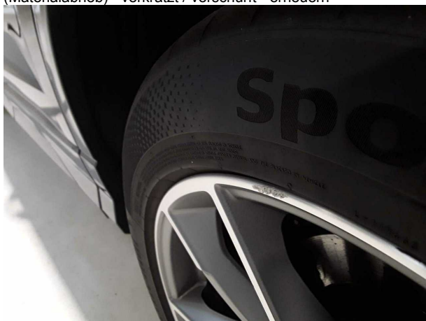
Beschädigung #8: Rad/Reifen: Leichtmetallfelge hinten links (Materialabrieb) - verkratzt / verschürft - erneuern
