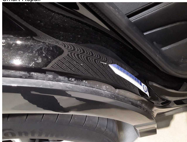
Beschädigung #4: Karosserie: C-Säule rechts unten - Kratzer... Smart Repair
