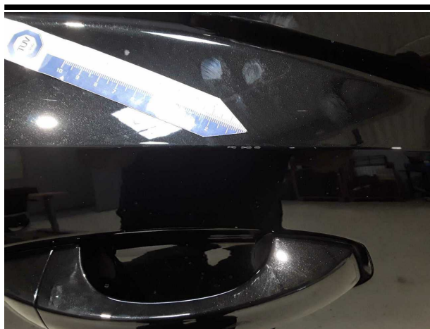
Beschädigung #9: Tür hinten rechts: Tür - Kratzer - lackieren
