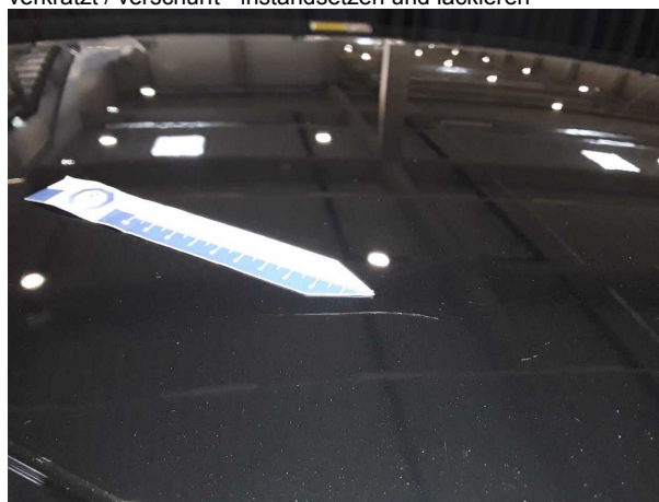
Beschädigung #11: Fahrzeugdach: Dach - Kratzer - lackieren
