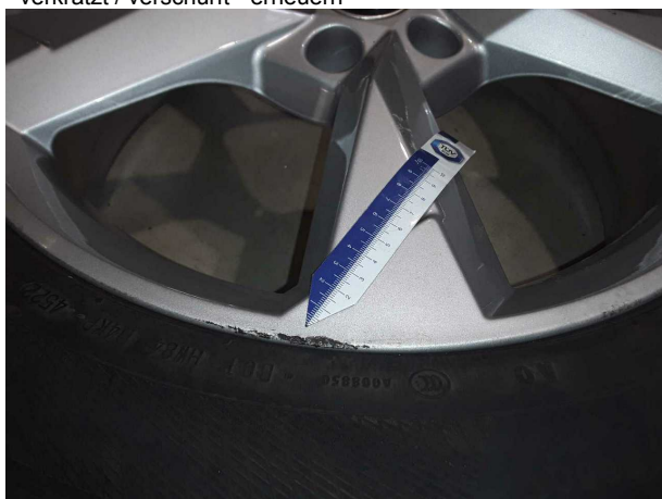
Beschädigung #7: 2.Radsatz: 1 Leichtmetallfelge (Materialabrieb) - verkratzt / verschürft - erneuern
