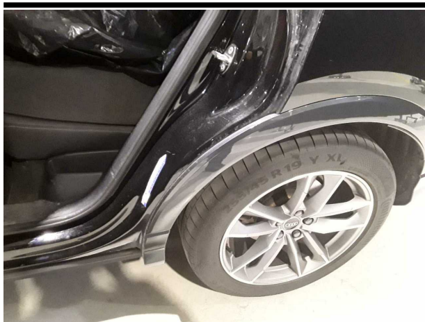
Beschädigung #3: Karosserie: C-Säule links unten - Kratzer - Smart Repair
