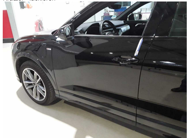
Beschädigung #2: Tür vorn links: Zierleiste Mitte - verkratzt / verschürft - erneuern
