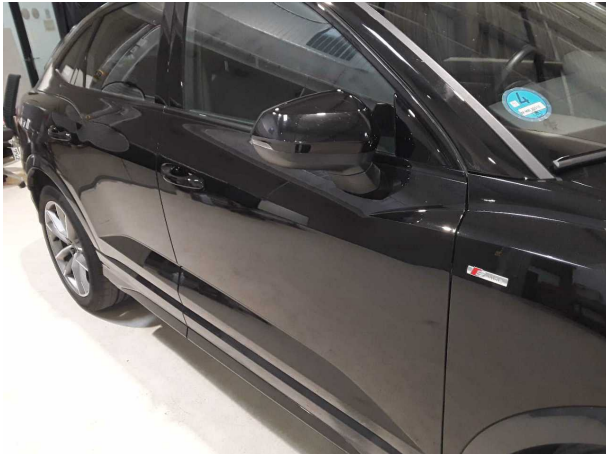
Beschädigung #1: Außenspiegel rechts: Abdeckkappe - Kratzer - lackieren
