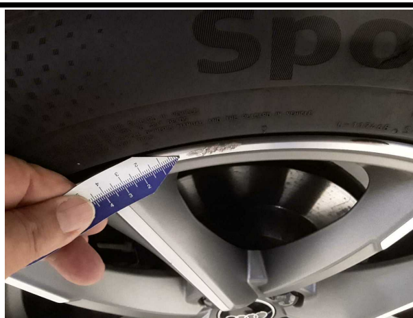
Beschädigung #8: Rad/Reifen: Leichtmetallfelge hinten links (Materialabrieb) - verkratzt / verschürft - erneuern
