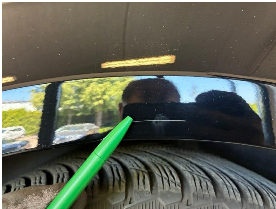
Bild 21 : Kotflügel vorne links Kratzer
