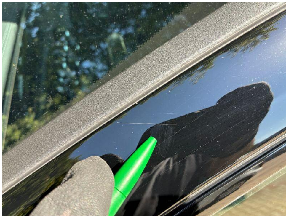
Bild 22 : Dachrahmen links Kratzer
