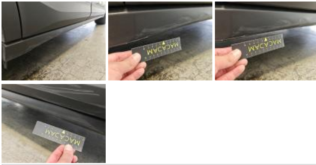
Door trim FR, Scratch(es), Replace
