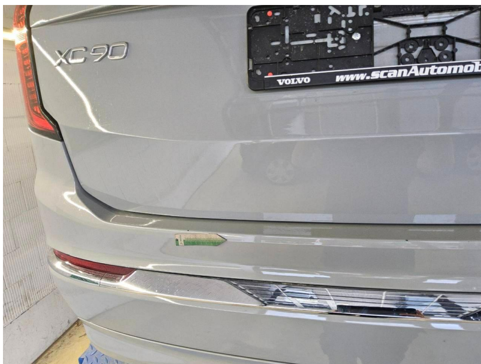
Bild 16 : Stoßfänger hinten Lackierung, zerkratzt, Gebrauchsspur
