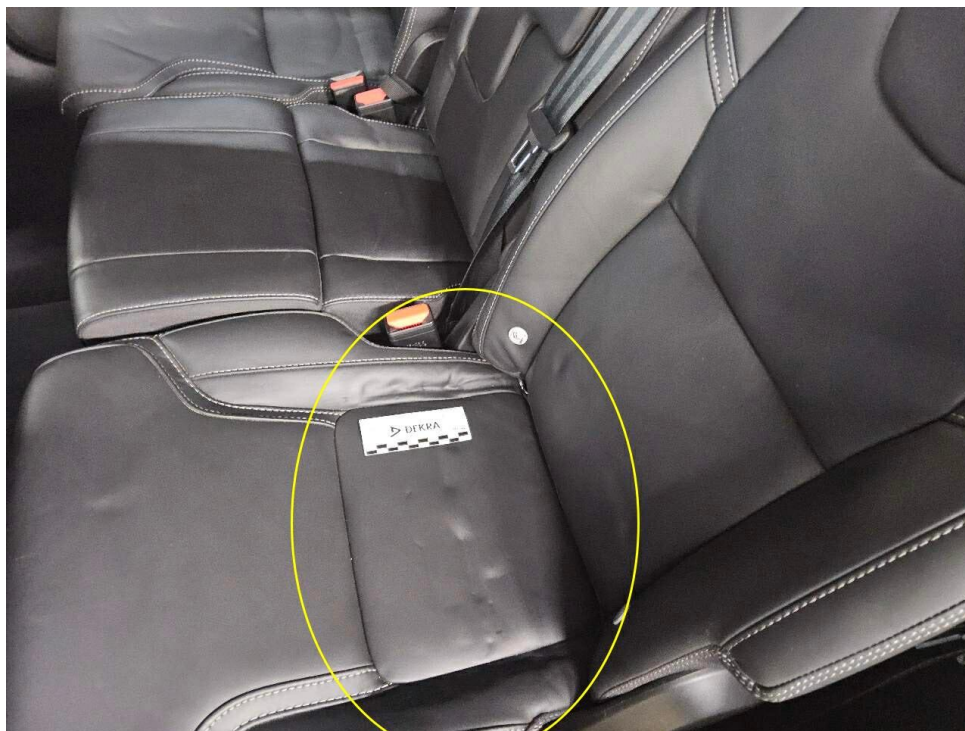
Bild 24 : zweite Sitzreihe, Rücksitz hinten links und rechts, Druckstellen
