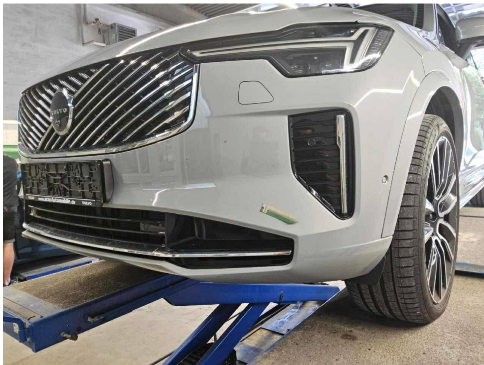
Bild 18 : Stoßfänger vorne Lackierung, Steinschlag, Gebrauchsspur
