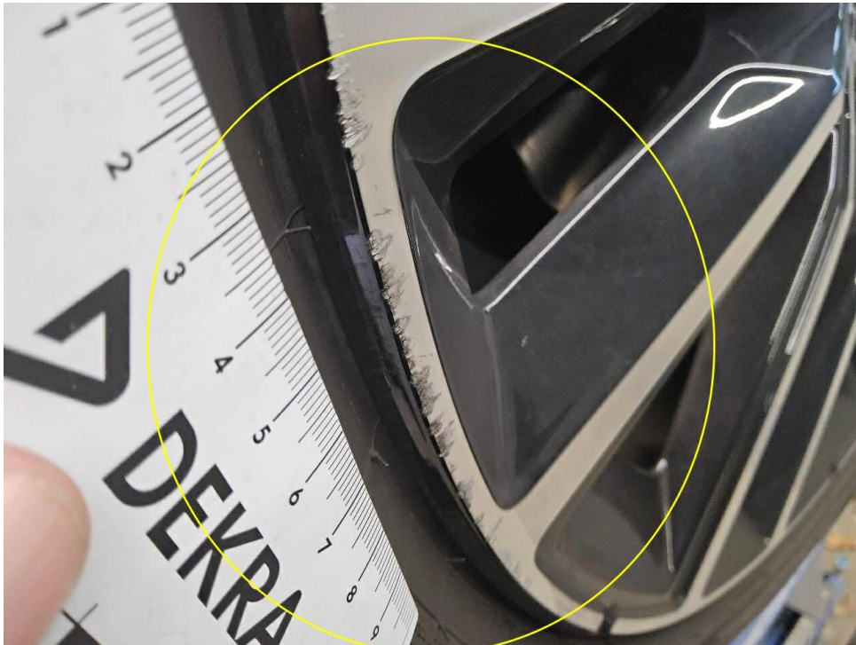
Bild 29 : LM Felge vorne rechts glanzgedreht verschrammt
