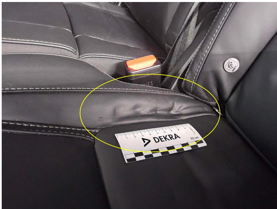
Bild 25 : zweite Sitzreihe, Rücksitz hinten links und rechts, Druckstellen
