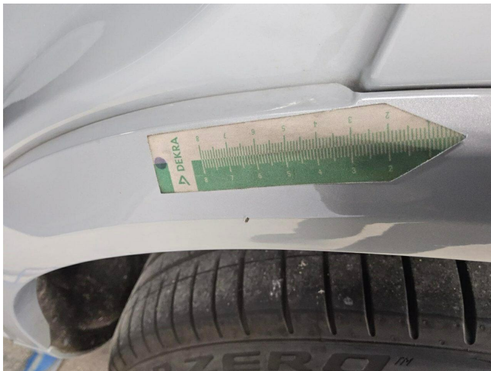
Bild 23 : Seitenteil hinten links Zierleiste Lackierung, zerkratzt, Gebrauchsspur
