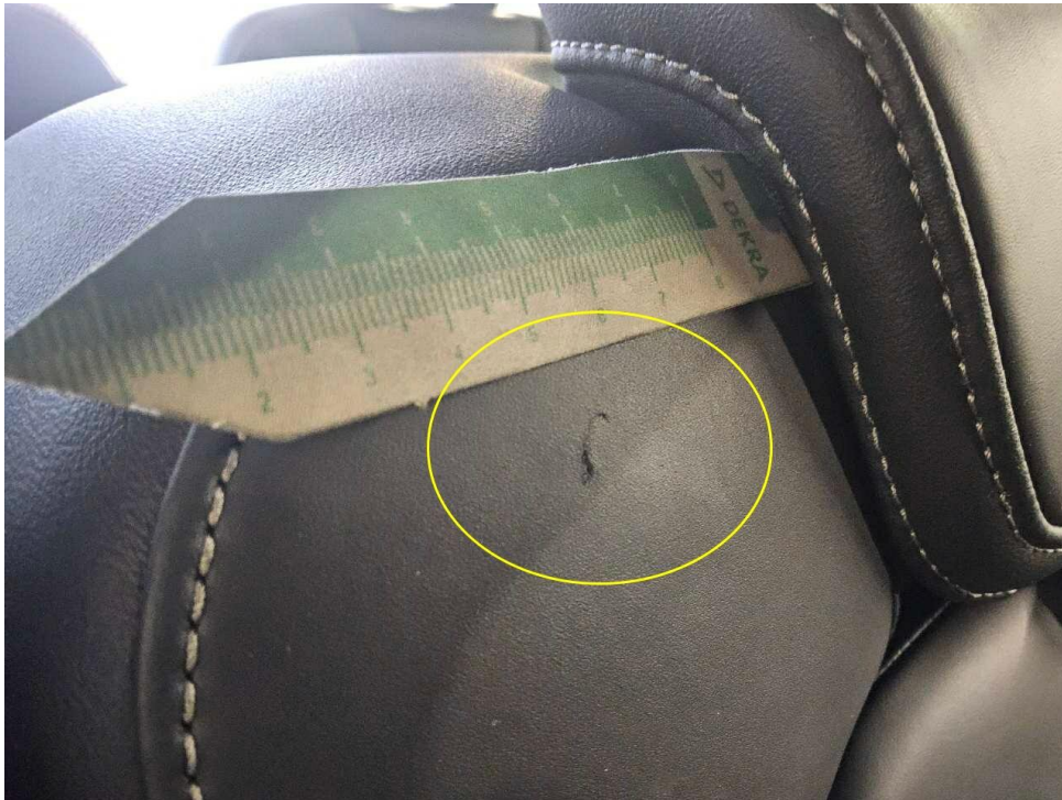
Bild 27 : zweite Sitzreihe, Rücksitzlehne mitte, zerkratzt
