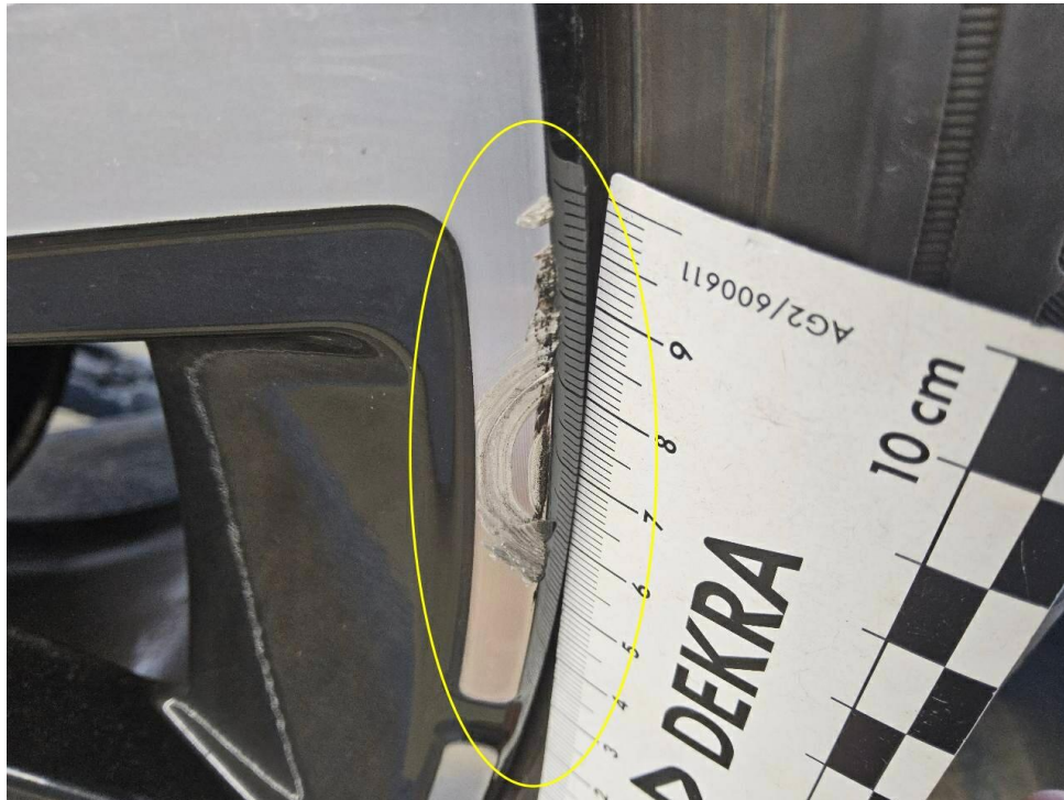
Bild 31 : LM Felge hinten links glanzgedreht verschrammt
