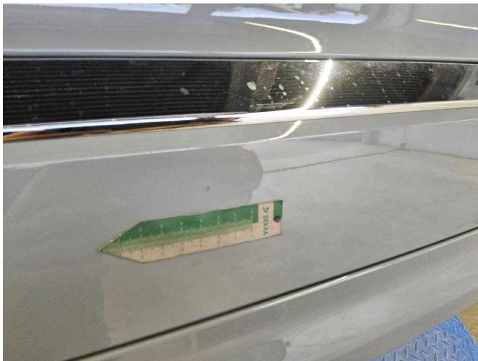
Bild 15 : Heckschürze hinten unten Lackierung, zerkratzt, Gebrauchsspur
