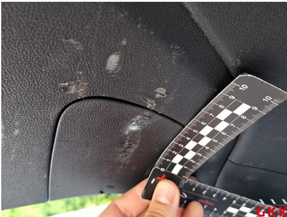
Bild 36. Heckklappe, Innenverkleidung, verkratzt, ersetzen
