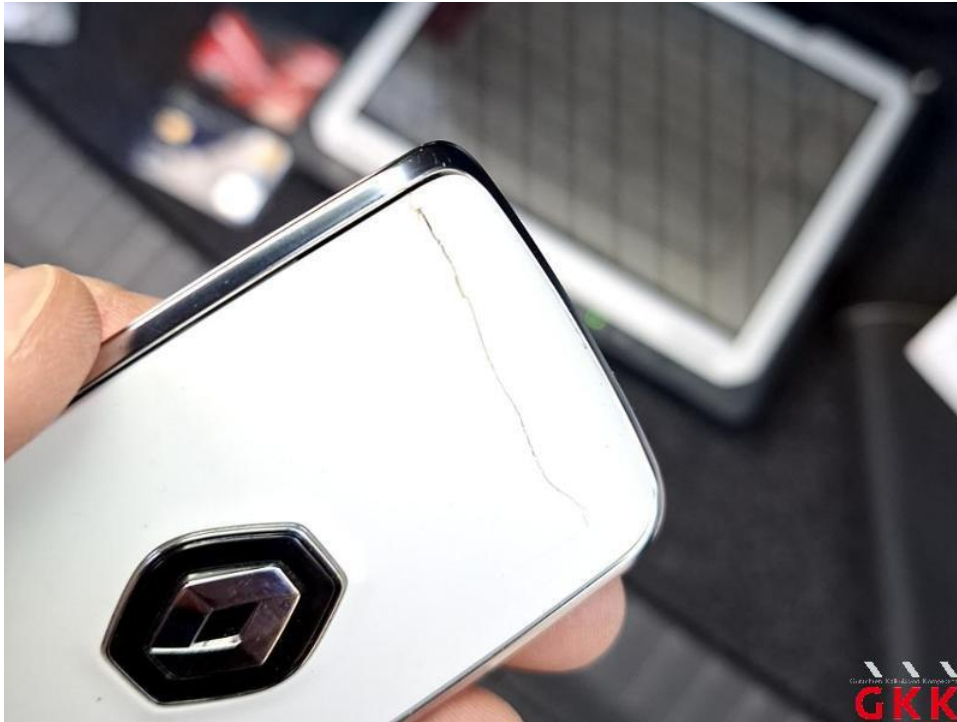
Bild 13. Hauptschlüssel, mit Fernbedienung, beschädigt, ersetzen
