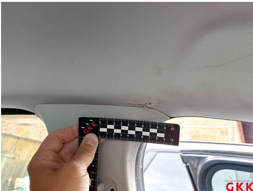
Bild 21. Himmel, beschädigt, ersetzen
