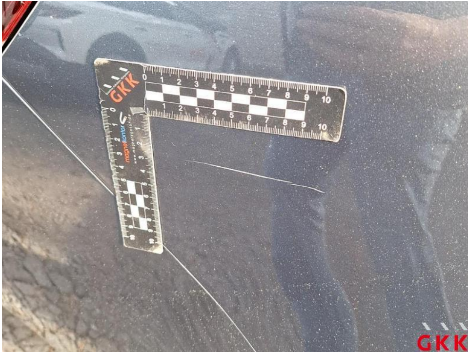
Bild 25. Seitenwand rechts, verkratzt, lackieren
