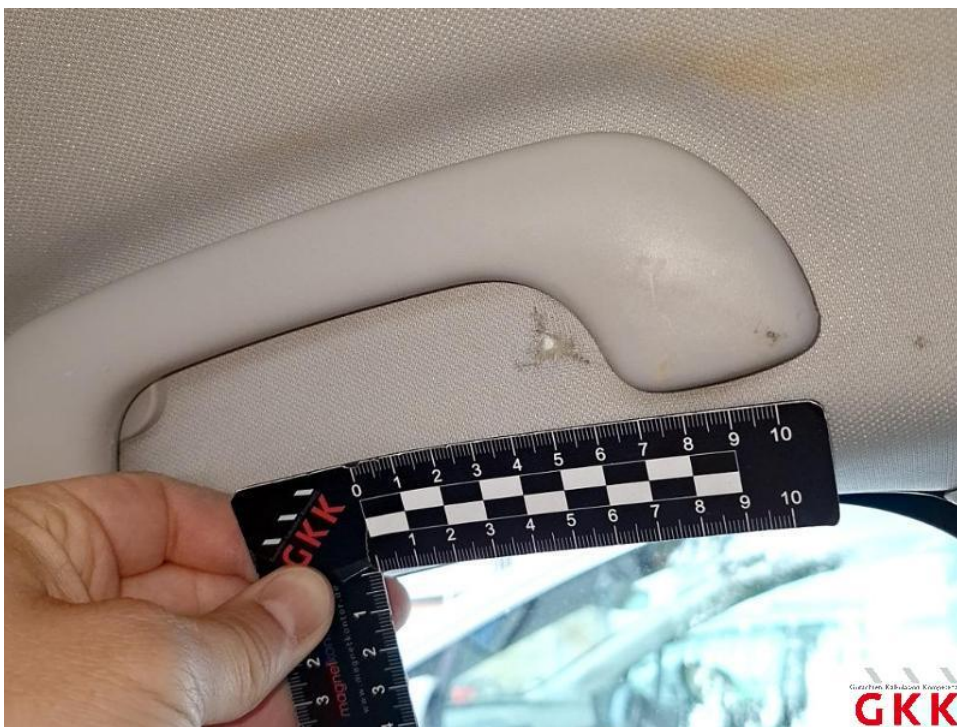
Bild 22. Himmel, beschädigt, ersetzen
