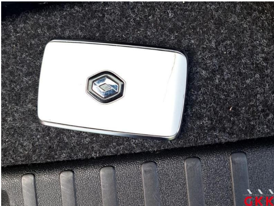
Bild 12. Hauptschlüssel, mit Fernbedienung, beschädigt, ersetzen
