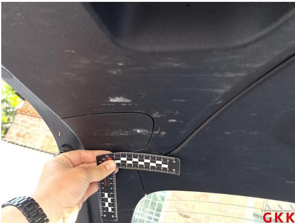
Bild 34. Heckklappe, Innenverkleidung, verkratzt, ersetzen
