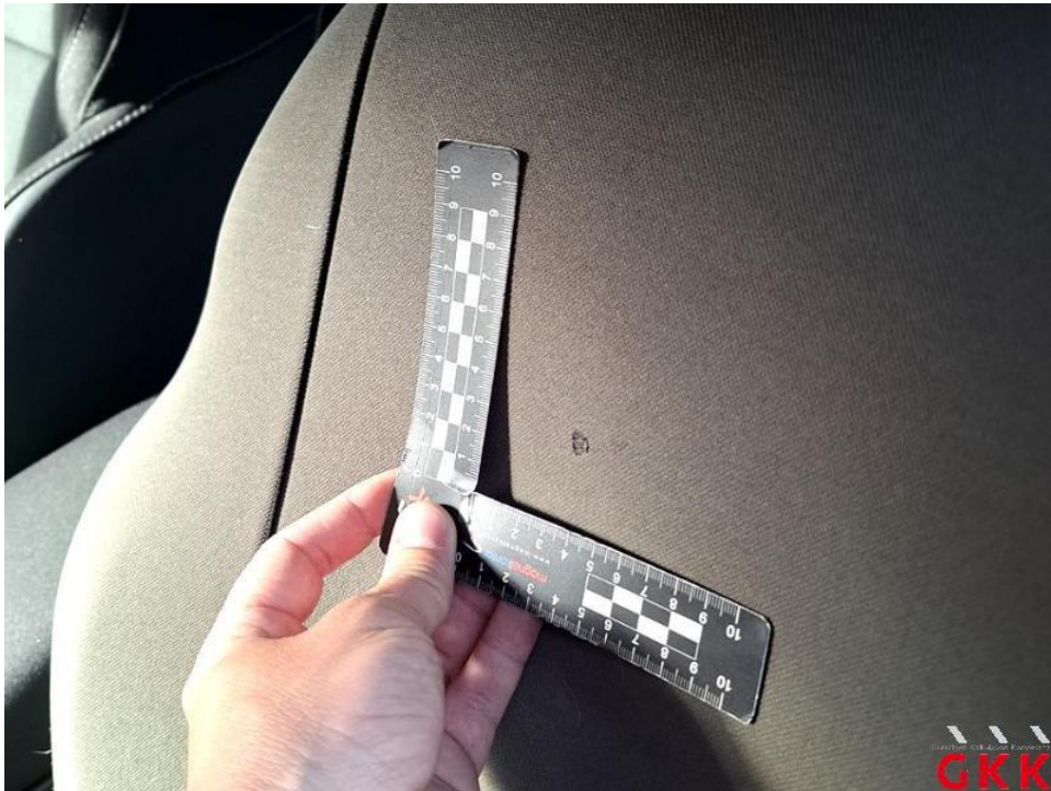
Bild 42. Sitz vorne links, Schonbezug, gerissen, ersetzen
