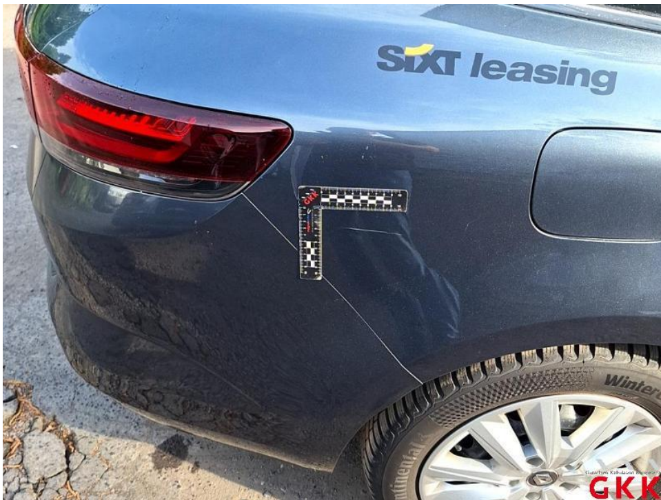
Bild 24. Seitenwand rechts, verkratzt, lackieren
