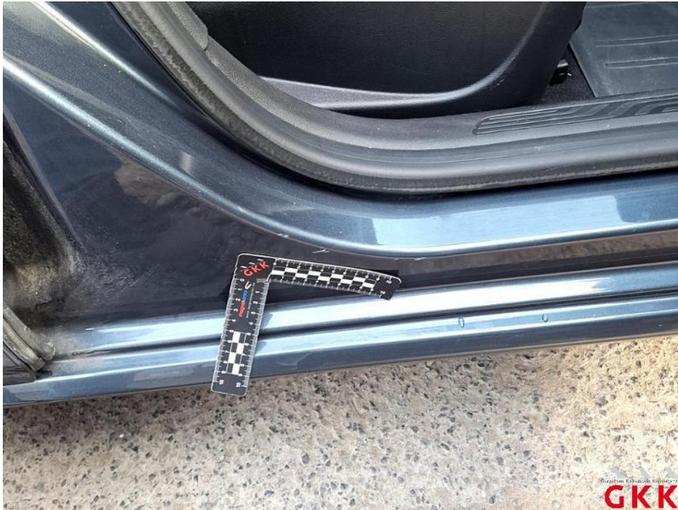
Bild 17. Tür vorne rechts, Einstieg, verkratzt, Smartrepair
