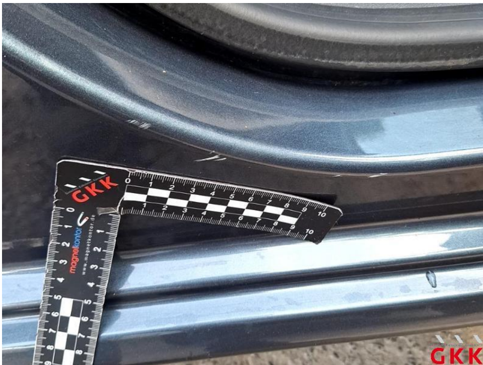
Bild 18. Tür vorne rechts, Einstieg, verkratzt, Smartrepair
