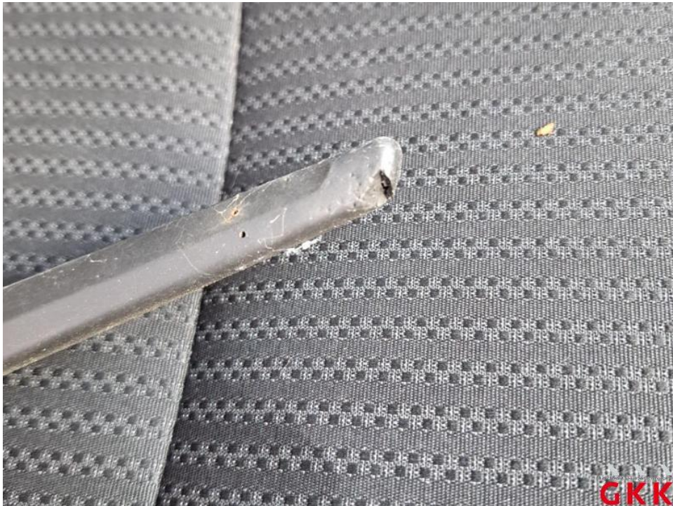
Bild 20. Antenne, Stab, beschädigt, ersetzen
