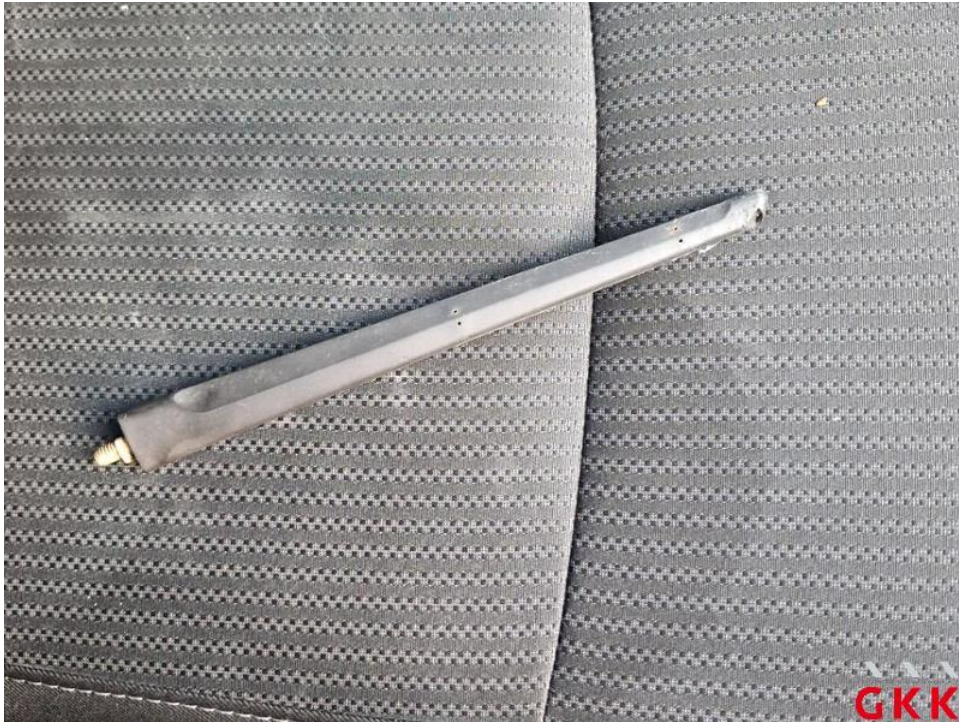
Bild 19. Antenne, Stab, beschädigt, ersetzen
