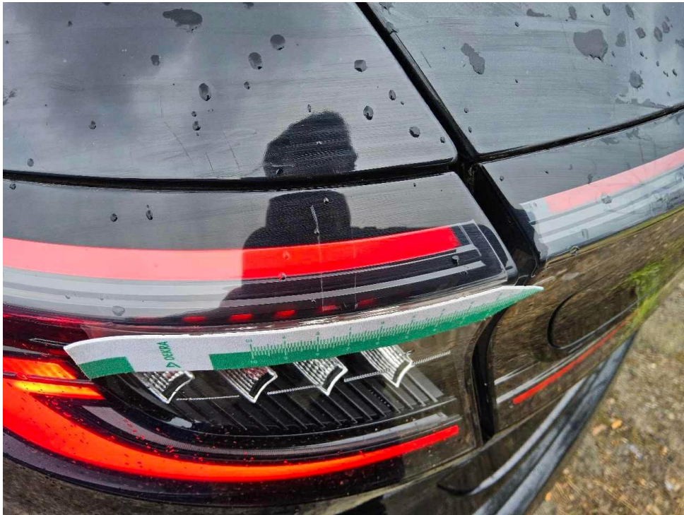
Bild 19 : Rückleuchte links außen, zerkratzt
