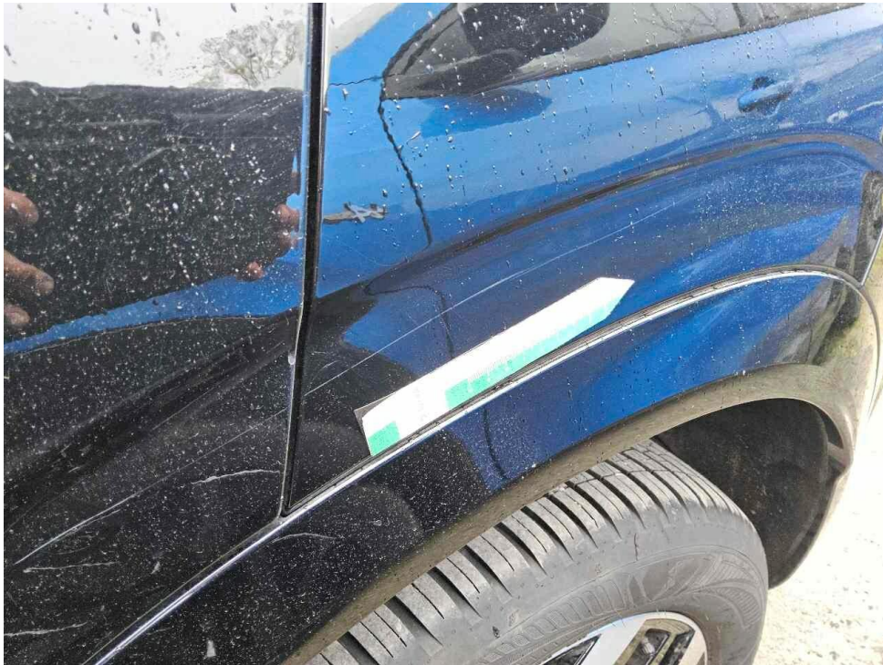
Bild 21 : Seitenteil hinten links Lackierung, zerkratzt, lackieren
