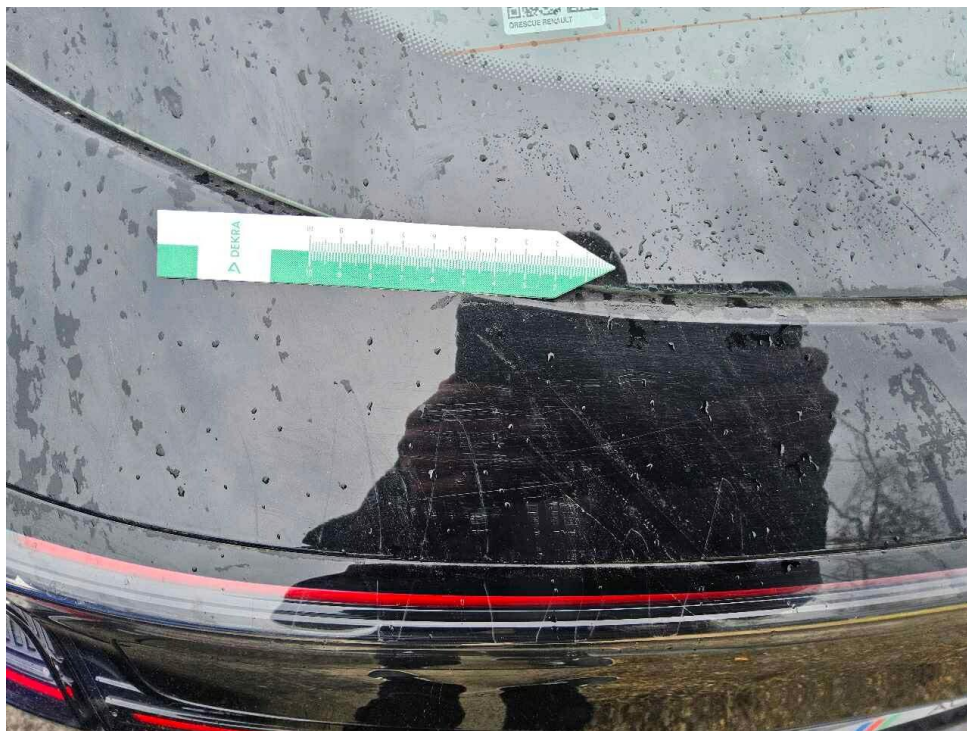
Bild 16 : Heckklappe Lackierung, zerkratzt, lackieren
