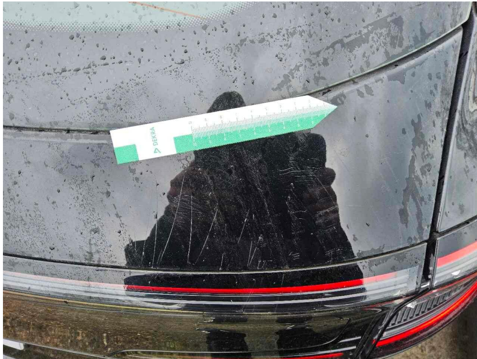
Bild 15 : Heckklappe Lackierung, zerkratzt, lackieren
