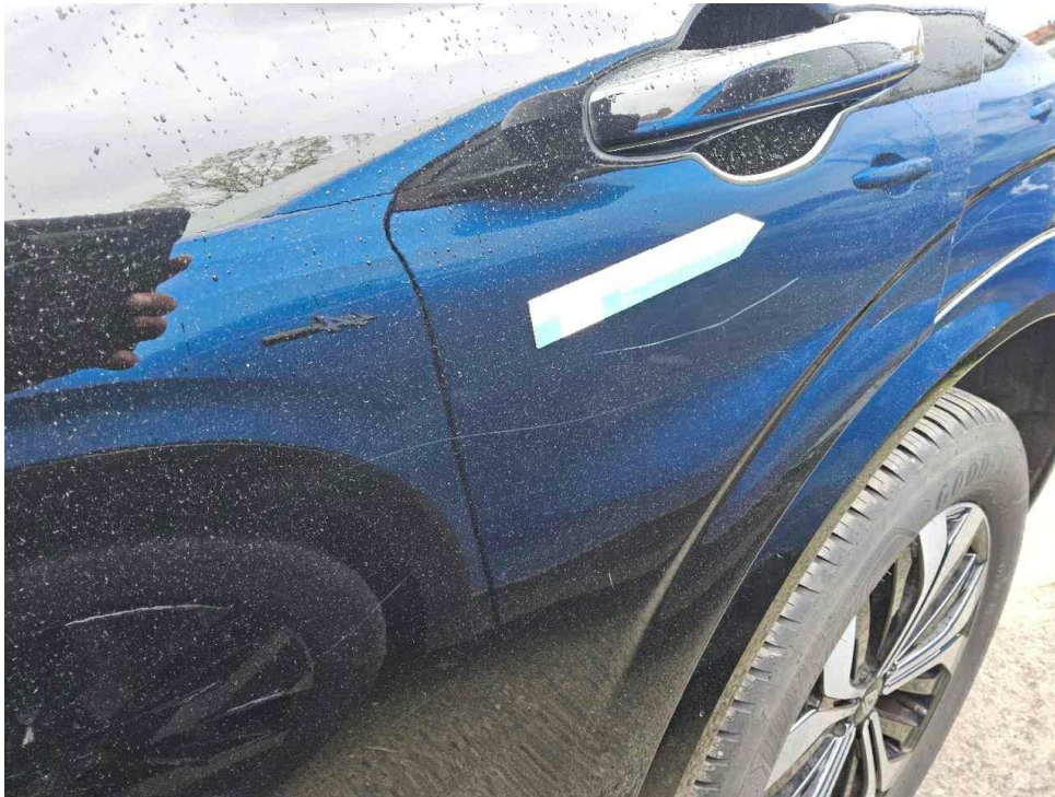
Bild 11 : Tür hinten links Lackierung, zerkratzt, lackieren
