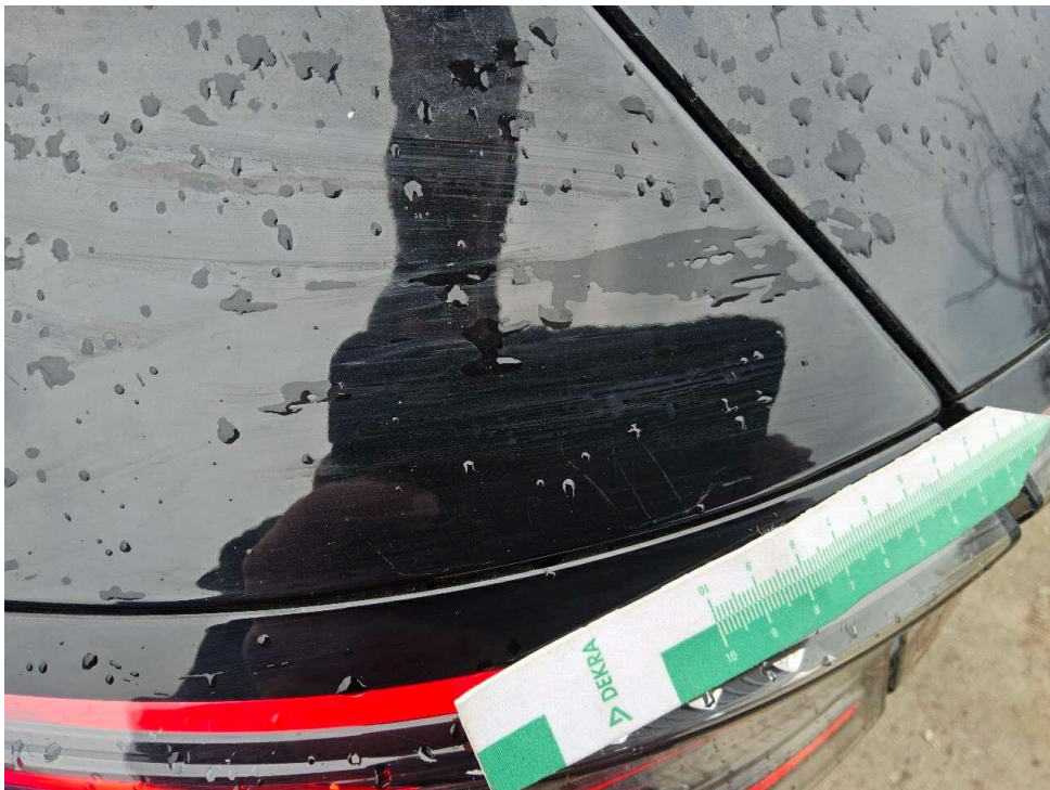
Bild 22 : Seitenteil hinten links Lackierung, zerkratzt, lackieren
