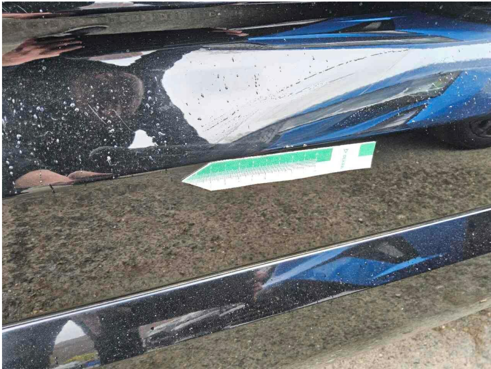
Bild 23 : Tür vorne links Lackierung, zerkratzt, lackieren
