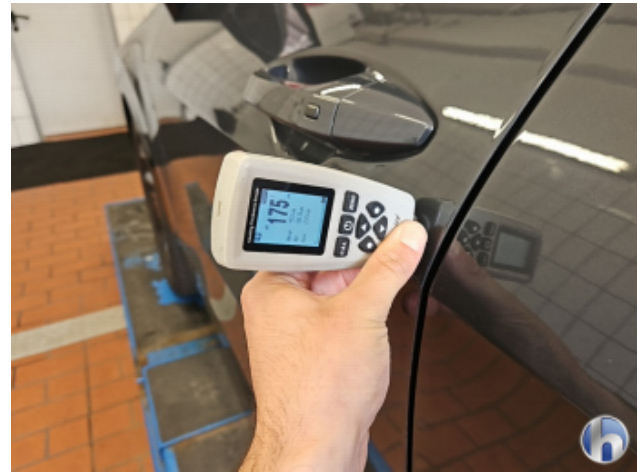
7. Tür Vorne - Links Nachlackiert - Ohne Reparatur
