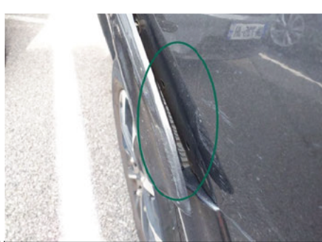
Extension d'aile / Arrière Gauche / Cassé
