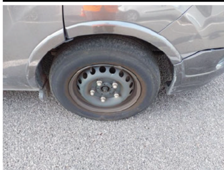
Pneu / Avant Droit / Non Conforme
