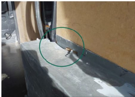
Passage de roue / Arrière Droit / Cassé
