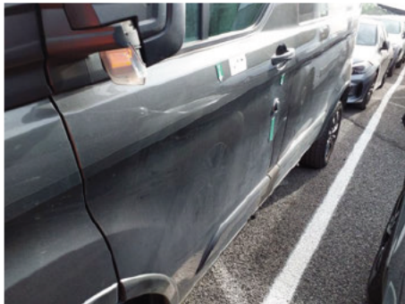
Porte / Avant Gauche / Enfoncement
