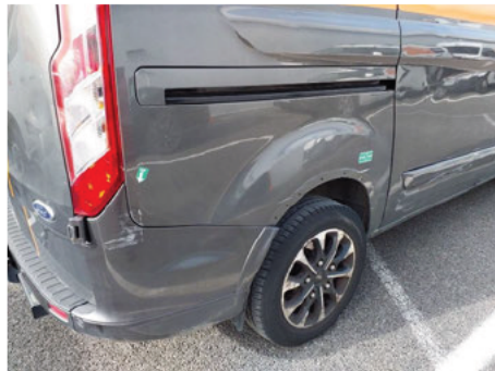
Aile / Arrière Droit / Enfoncement
