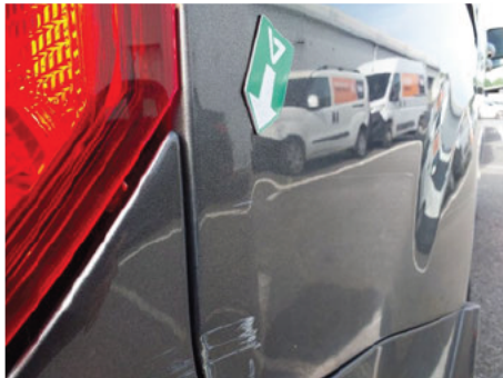
Aile / Arrière Droit / Enfoncement
