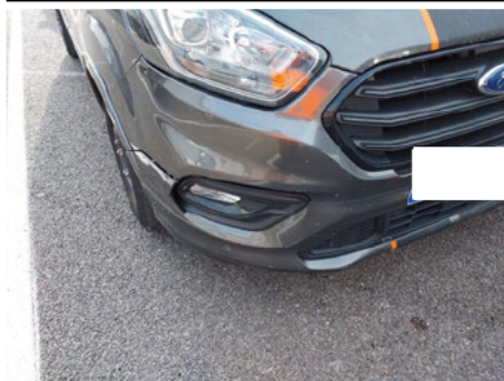
Enjoliveur d'antibrouillard / Avant Droit / Cassé
