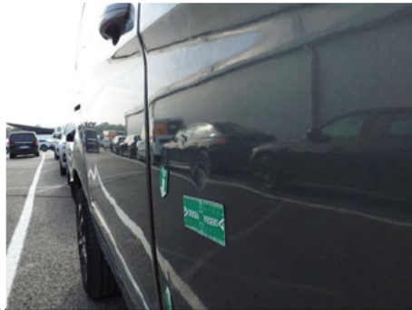
Porte / Avant Droit / Enfoncement
