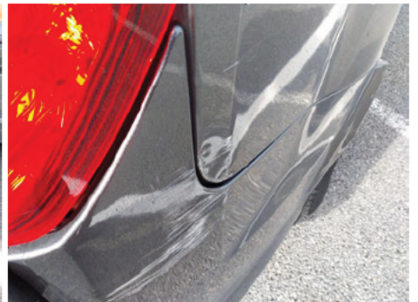
Aile / Arrière Droit / Enfoncement
