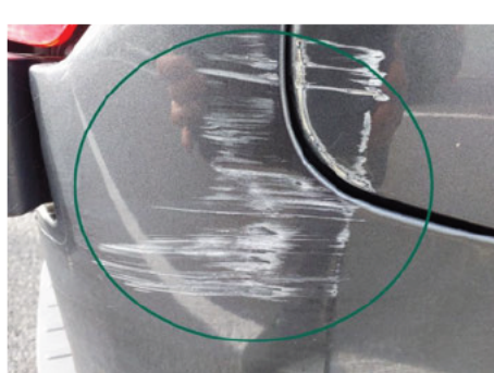
Pare-chocs / Arrière Droit / Rayure
