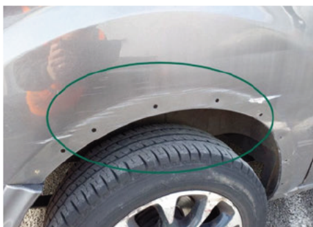
Extension d'aile / Arrière Droit / Manquant
