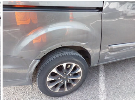
Extension d'aile / Arrière Droit / Manquant
