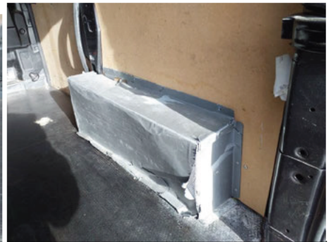
Passage de roue / Arrière Droit / Cassé
