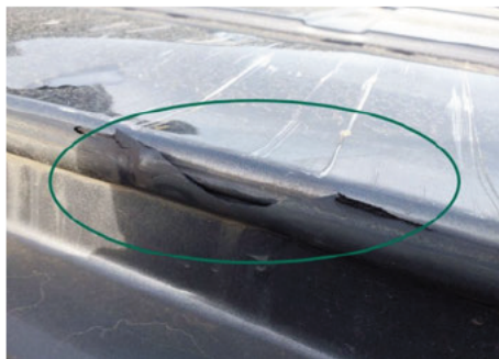
Joint de porte / Arrière / Déchiré
