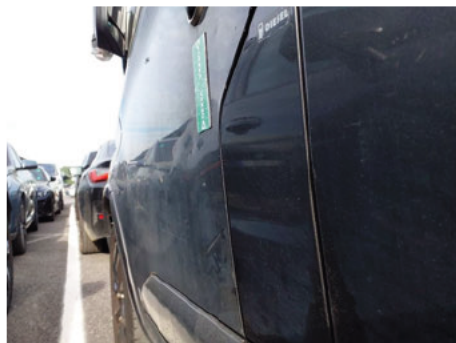
Porte / Avant Gauche / Enfoncement
