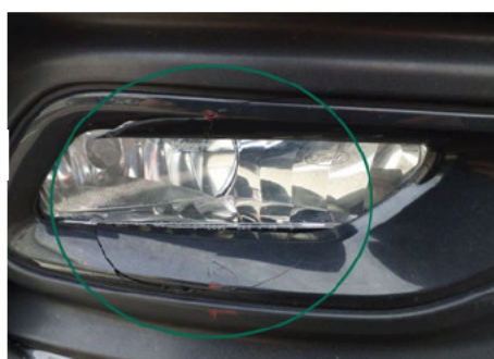
Enjoliveur d'antibrouillard / Avant Droit / Cassé
