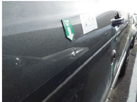
Porte / Avant Gauche / Enfoncement
