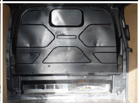
Panneau séparation cabine / - / Enfoncement
