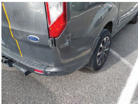
Pare-chocs / Arrière Droit / Rayure
