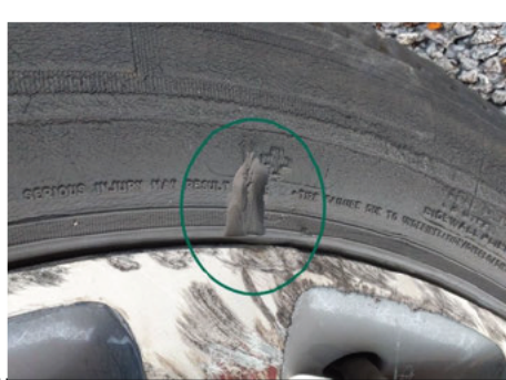
Pneu / Arrière Droit / Déchiré
