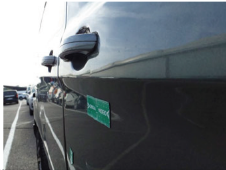
Porte / Avant Droit / Enfoncement
