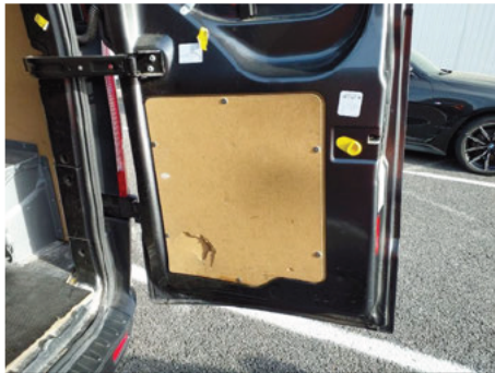
Garniture de porte / Arrière Droit / Cassé
