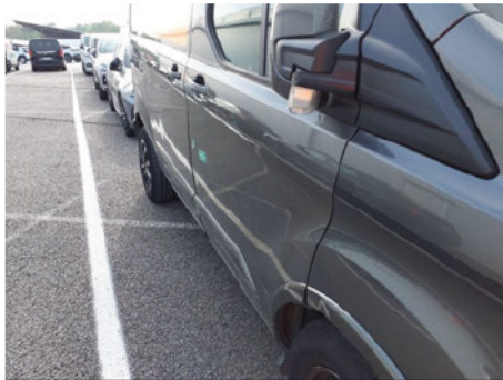
Porte / Avant Droit / Enfoncement
