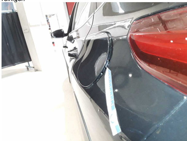
Beschädigung #4: Kraftstoffanlage: Tankdeckel (Tankdeckel schließt nicht) - Funktion / Zulässigkeit - befunden ggf.
