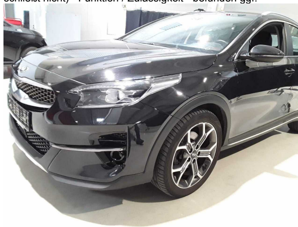
Beschädigung #5: Rad/Reifen: Leichtmetallfelge vorn links (Materialabrieb) - verkratzt / verschürft - erneuern
