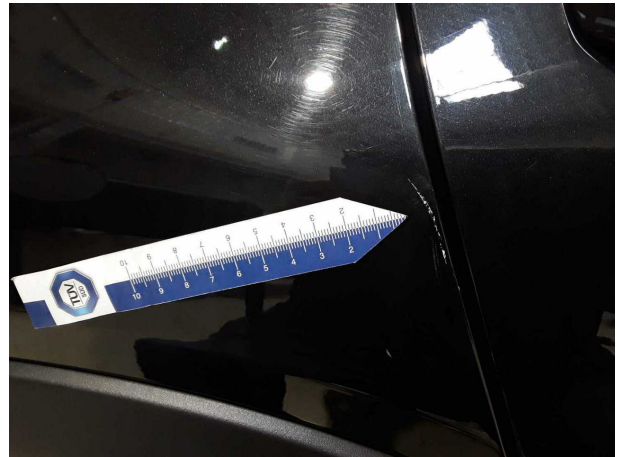
Beschädigung #8: Seitenwand rechts: Seitenwand - Kratzer - lackieren
