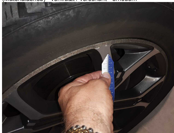
Beschädigung #6: Rad/Reifen: Leichtmetallfelge vorn rechts (Materialabrieb) - verkratzt / verschürft - erneuern
