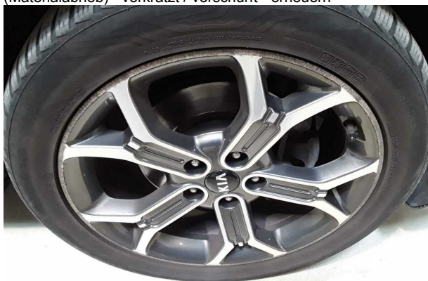
Beschädigung #5: Rad/Reifen: Leichtmetallfelge vorn links (Materialabrieb) - verkratzt / verschürft - erneuern
