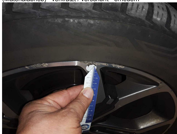
Beschädigung #5: Rad/Reifen: Leichtmetallfelge vorn links (Materialabrieb) - verkratzt / verschürft - erneuern
