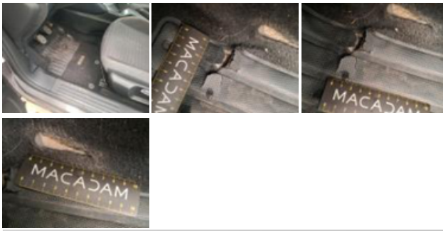
Joint de porte AVG, Déchirure, E - Remplacer
