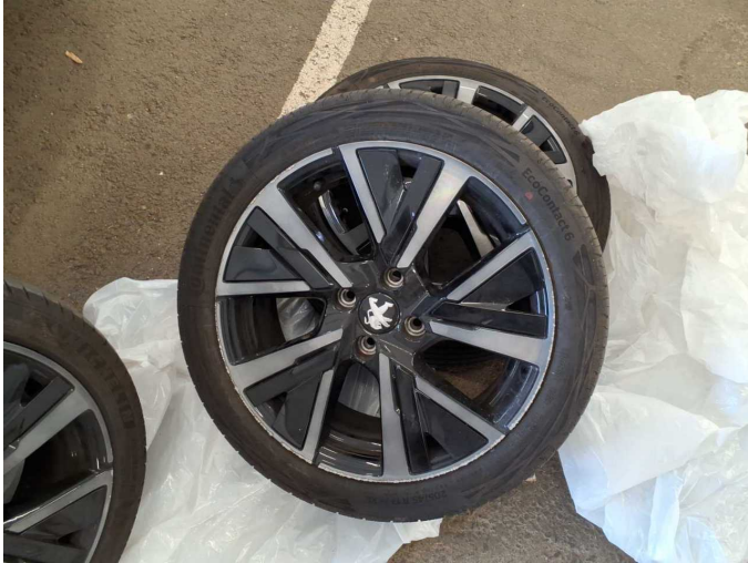
Damage 3: 2nd wheel set: 1 alloy rim (Mit Materialabtrag, Großflächig verkratzt) - Scratched - Replace
