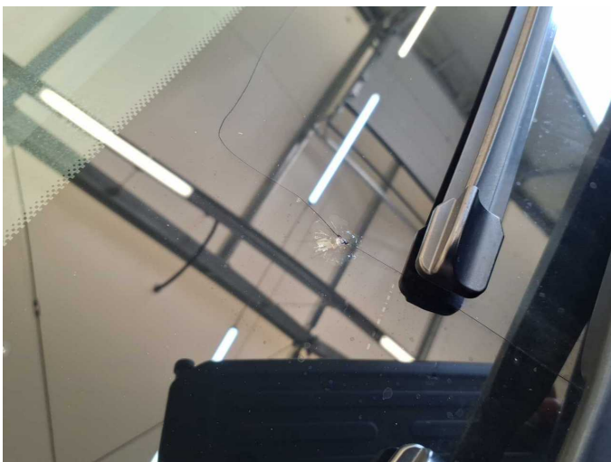
Damage 5: Vehicle glazing: Windscreen (Mit Rissbildung im Randbereich) - Stone chips - Replace
