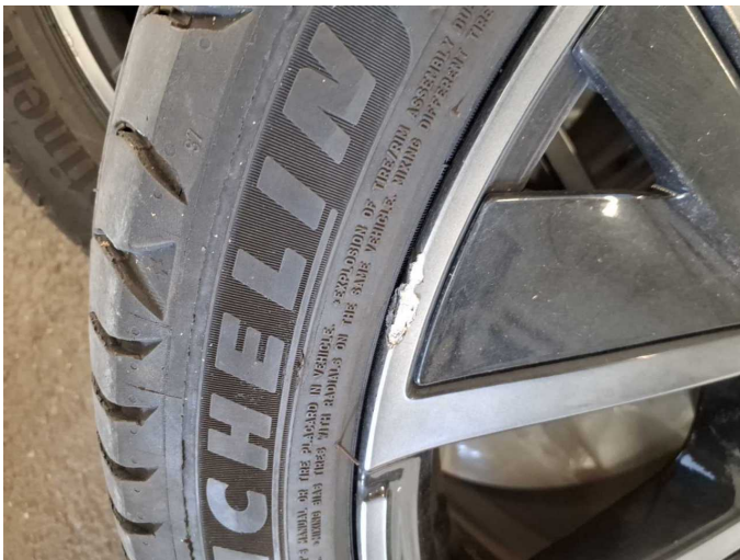
Damage 4: 2nd wheel set: 1 alloy rim (Mit Materialabtrag) - Scratched - Replace
