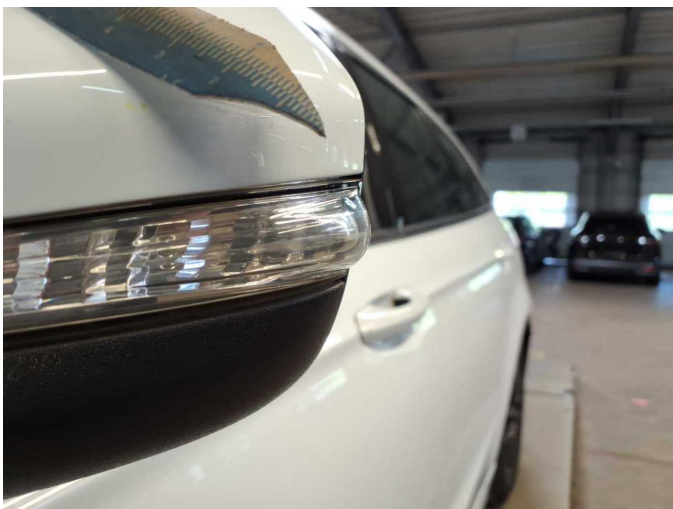
Damage 10: Indicator - front: Mirror - left side (Materialabtrag) - Scratch(es) - Replace
