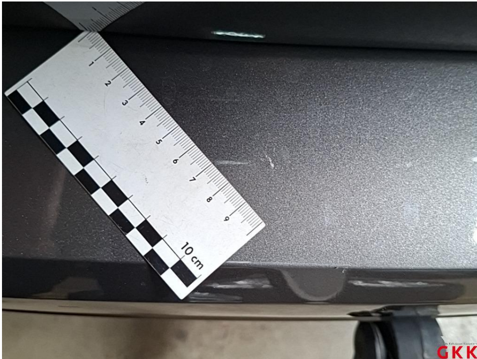
Bild 29 Stoßfänger hinten, Schutzfolie, beschädigt, ersetzen
