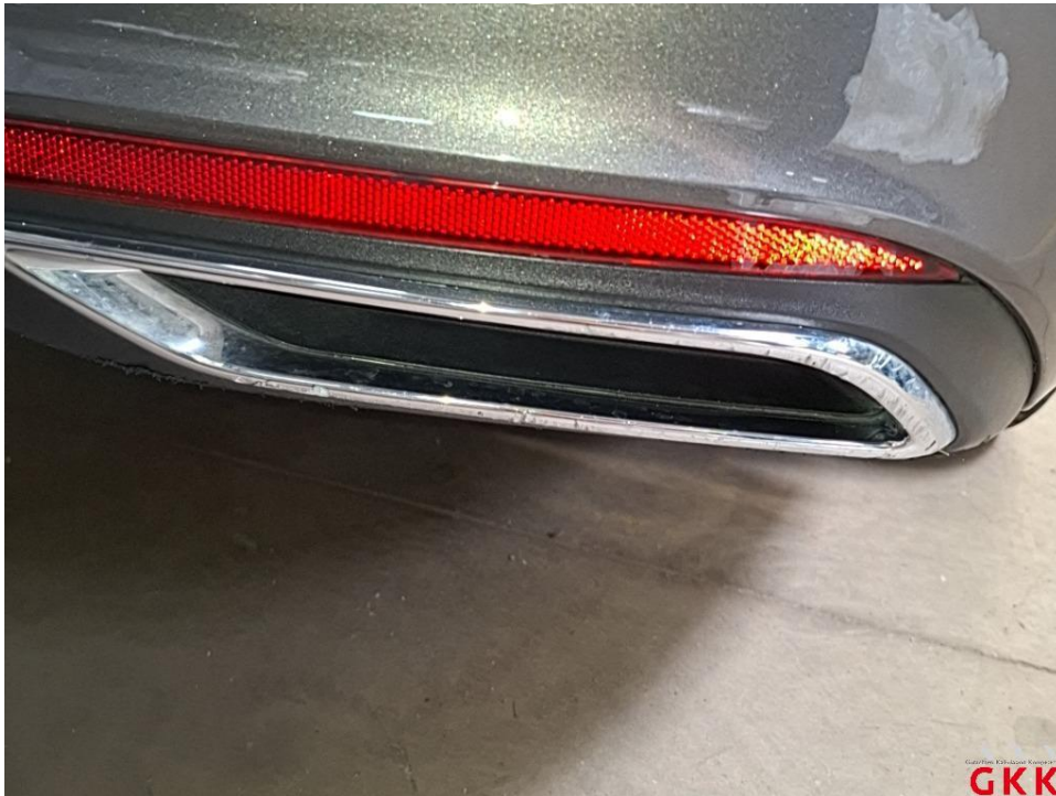
Bild 33 Stoßfänger hinten, Blende -unlackiert-, beschädigt, ersetzen
