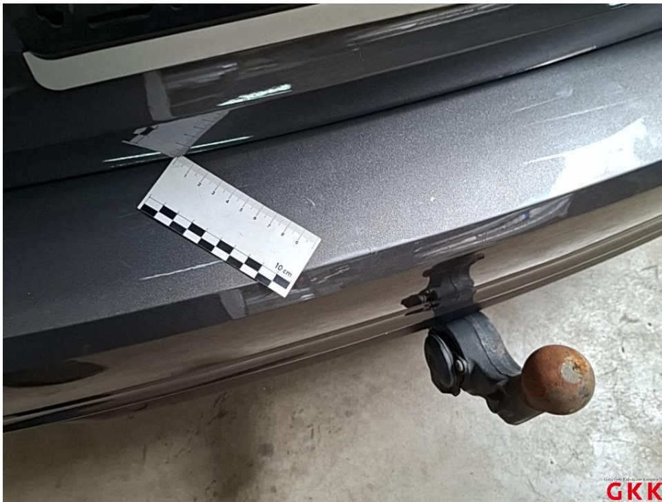
Bild 28 Stoßfänger hinten, Schutzfolie, beschädigt, ersetzen
