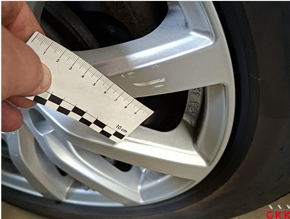
Bild 17 LM-Rad, vorne rechts, verkratzt, Smartrepair
