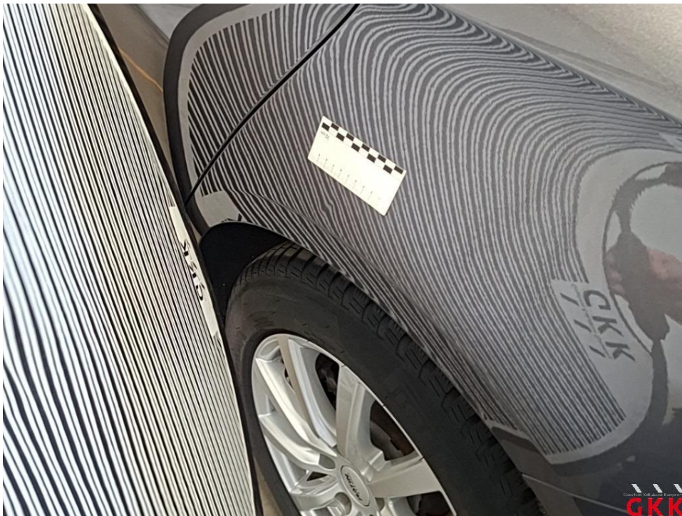
Bild 26 Seitenwand links, beschädigt, instand setzen - lackieren
