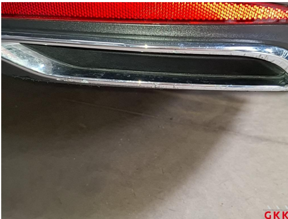
Bild 34 Stoßfänger hinten, Blende -unlackiert-, beschädigt, ersetzen
