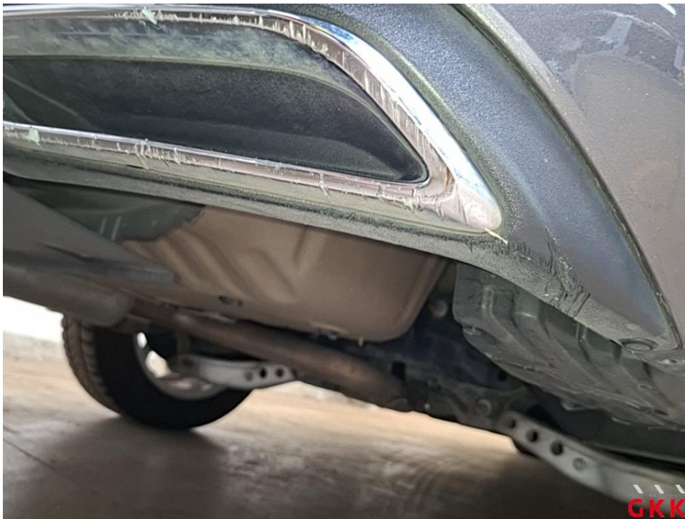
Bild 36 Stoßfänger hinten, Spoiler -unlackiert-, beschädigt, ersetzen
