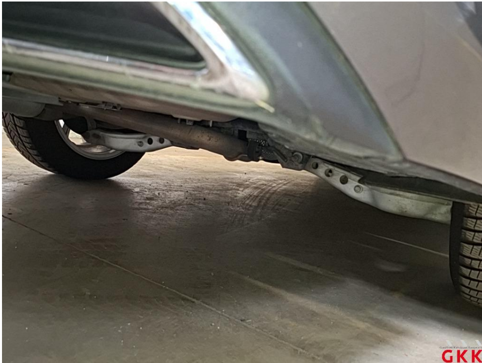
Bild 35 Stoßfänger hinten, Spoiler -unlackiert-, beschädigt, ersetzen
