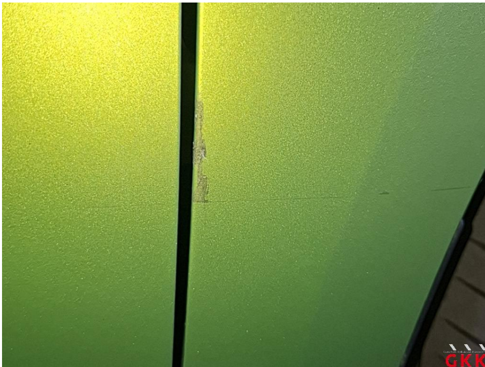
Bild 18 Fahrzeug, außen, Lackierung verwittert / matt, aufbereiten
