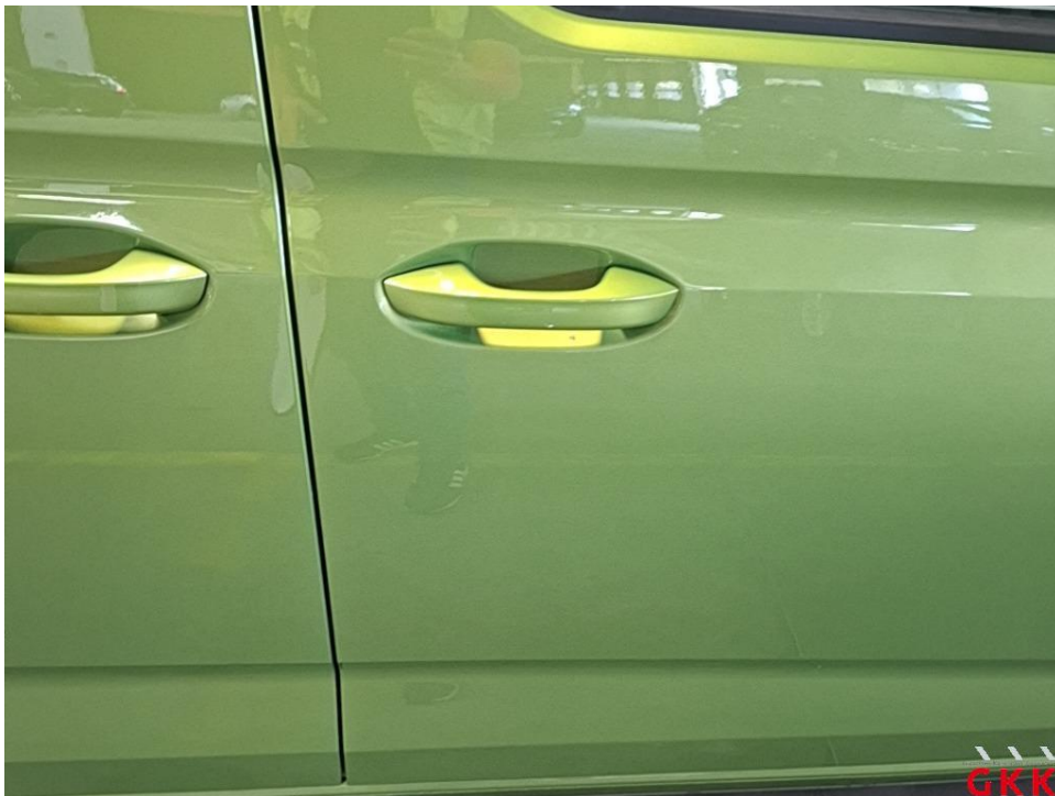
Bild 20 Tür vorne rechts, Griff, verkratzt, Smartrepair
