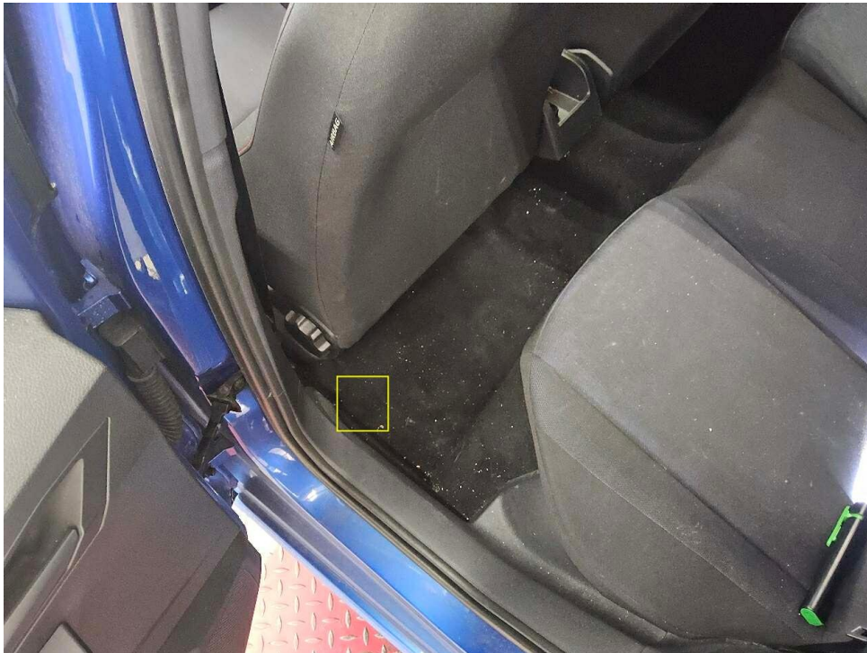
Bild 25 : Bodenbelag vorne links, verschlissen
