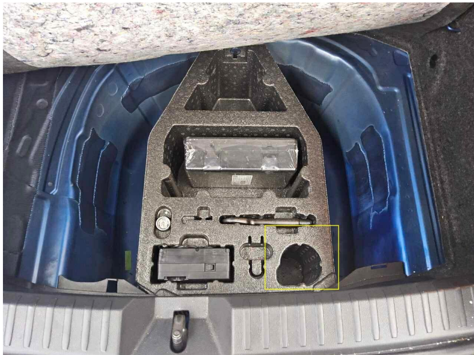
Bild 28 : Pannenset Reifendichtmittel, fehlt
