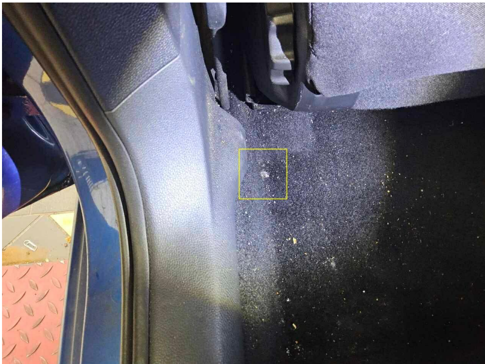
Bild 26 : Bodenbelag vorne links, verschlissen
