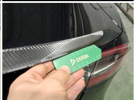
Becquet / Arrière / Non Conforme
