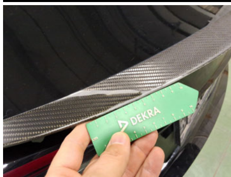
Becquet / Arrière / Non Conforme
