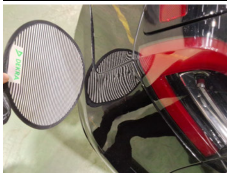
Pare-chocs / Arrière / Enfoncement
