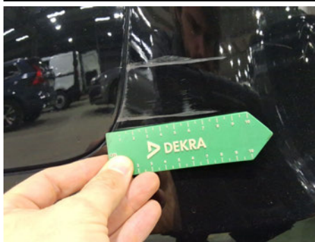
Pare-chocs / Arrière / Enfoncement
