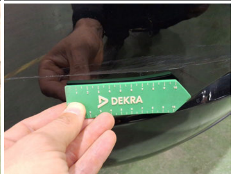
Pare-chocs / Arrière / Enfoncement
