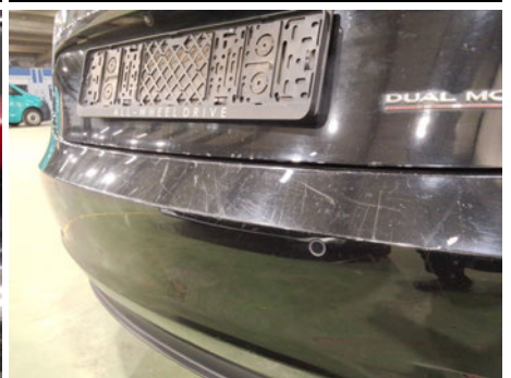
Pare-chocs / Arrière / Enfoncement
