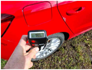
Lackstärke Seitenwand hinten rechts
