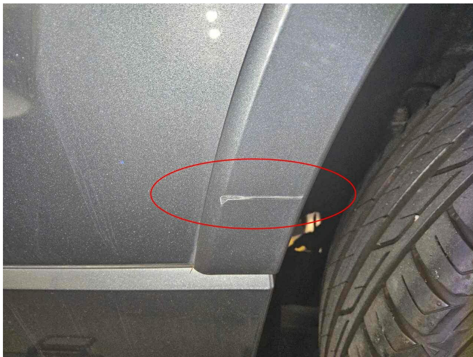
Bild 21 : Türe hinten links Blende verkratzt
