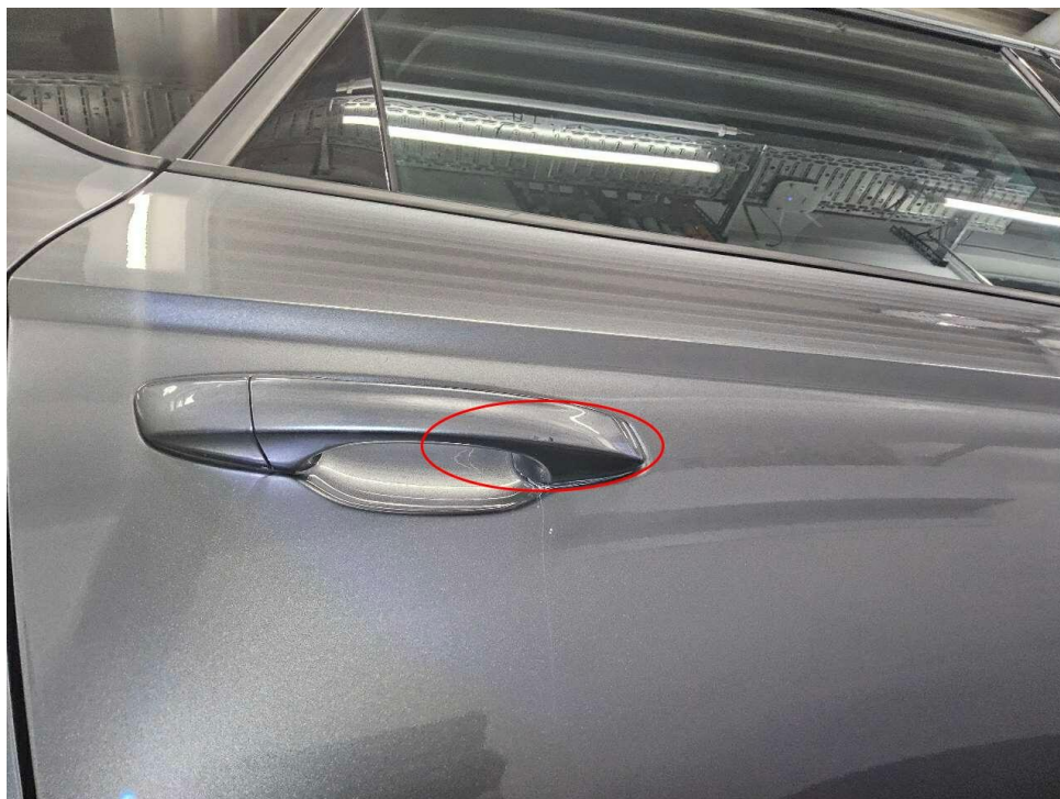
Bild 26 : Türgriff hinten rechts verkratzt
