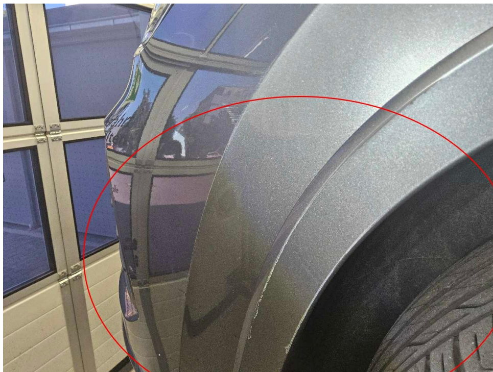
Bild 19 : Streifschaden Stoßfänger vorne links
