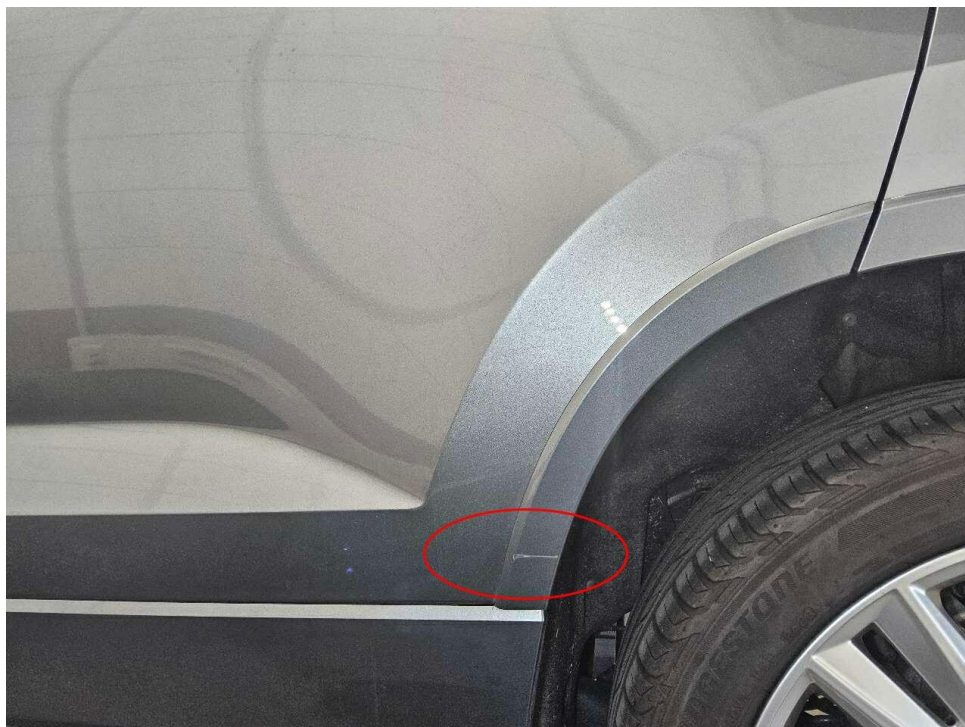
Bild 22 : Türe hinten links Blende verkratzt
