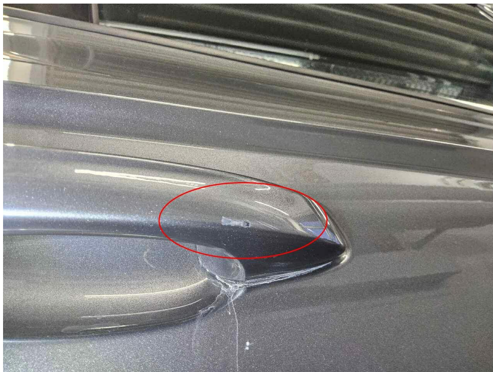
Bild 25 : Türgriff hinten rechts verkratzt
