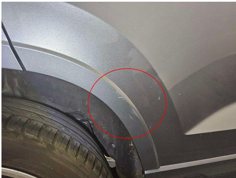
Bild 24 : Türe hinten rechts eingedellt und verkratzt
