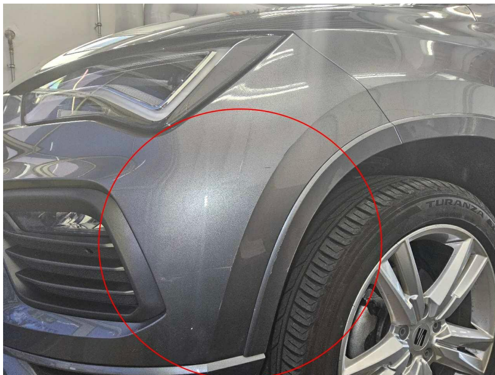
Bild 18 : Streifschaden Stoßfänger vorne links
