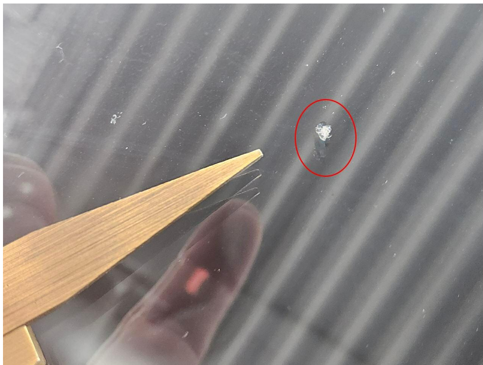
Bild 15 : Windschutzscheibe Steinschlag mit Rissbildung im Sichtfeld
