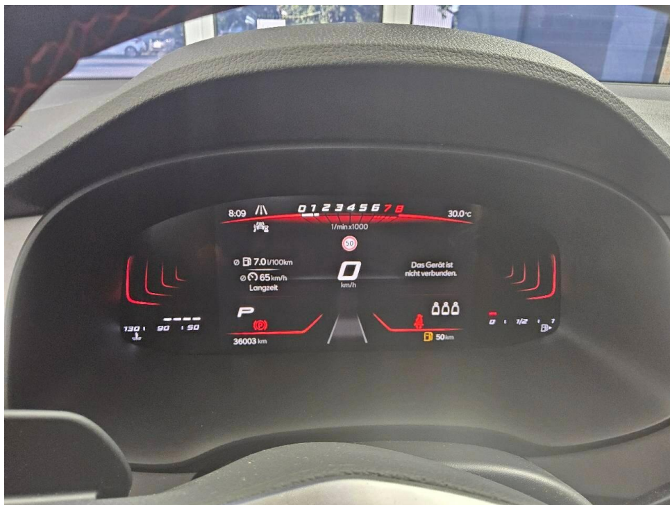
Bild 6 : Kombiinstrument (betriebsbereit) mit Km-Stand
