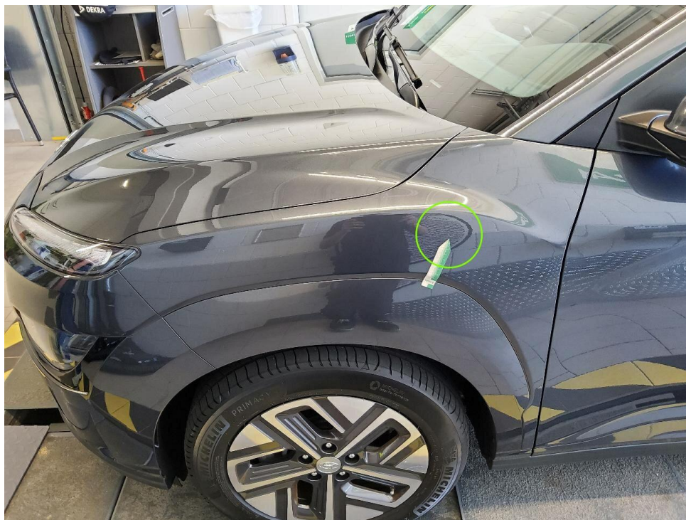
Bild 14 : Kotflügel vorne links Kratzer
