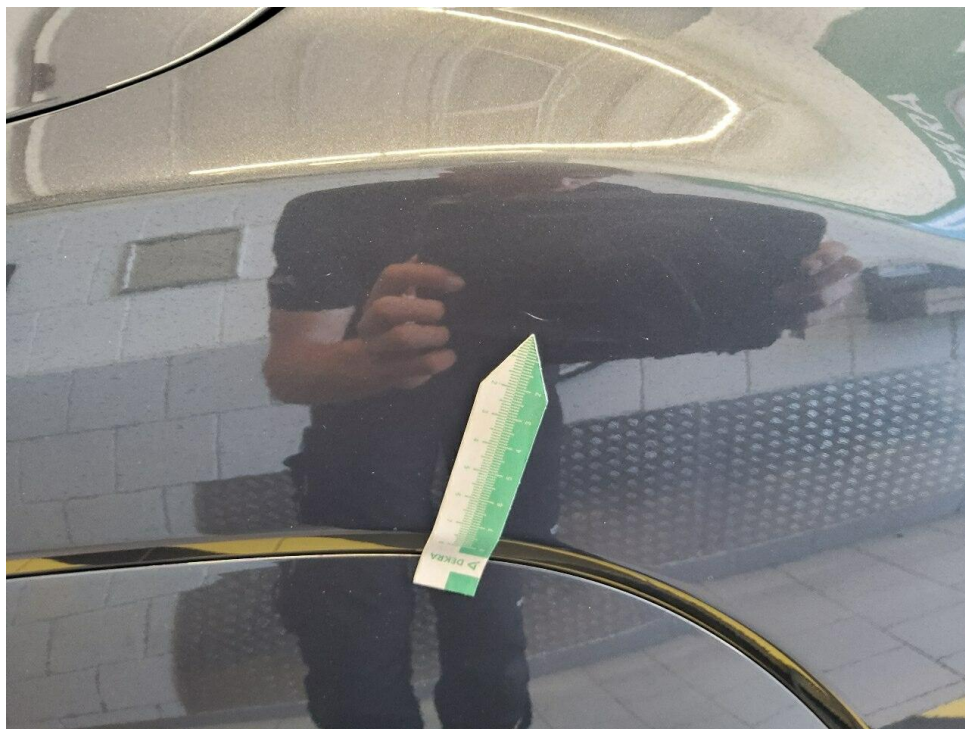
Bild 15 : Kotflügel vorne links Kratzer
