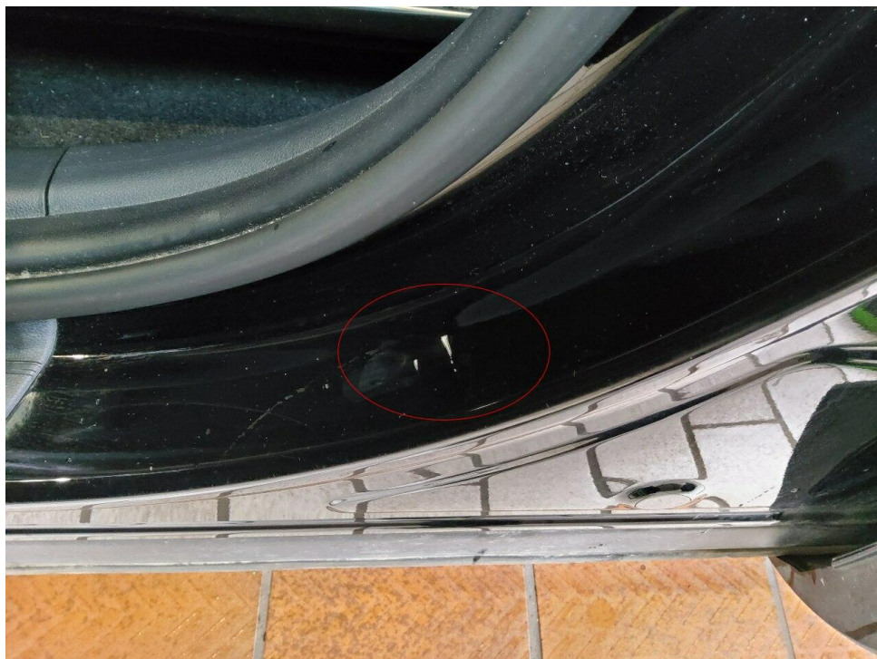
Bild 10 : Türeinstieg VL verkratzt
