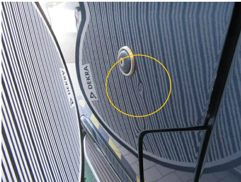
Bild 16 : Tür vorne links, eingedellt
