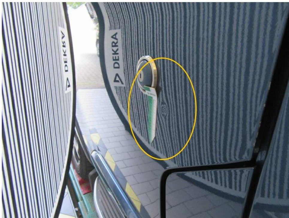
Bild 17 : Tür vorne links, eingedellt
