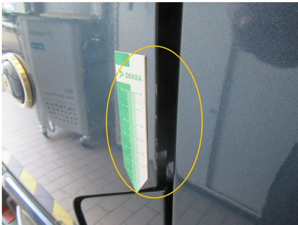
Bild 15 : Türkante vorne links, Lackschaden
