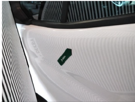
Tür / Vorne Links / Delle
