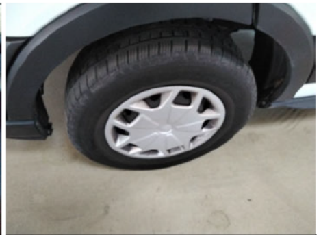
Reifen / Vorne Links / Verschlissen
