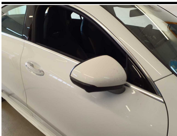
Beschädigung #4: Blinkleuchte: Spiegel rechts - verkratzt / verschürft - erneuern
