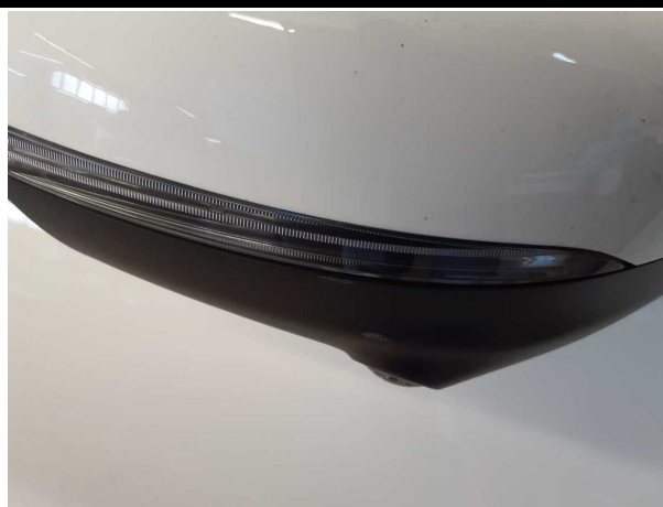
Beschädigung #4: Blinkleuchte: Spiegel rechts - verkratzt / verschürft - erneuern
