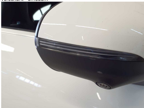
Beschädigung #4: Blinkleuchte: Spiegel rechts - verkratzt / verschürft - erneuern
