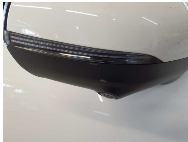
Beschädigung #1: Außenspiegel rechts: Spiegelgehäuse - verkratzt / verschürft - Wertminderung
