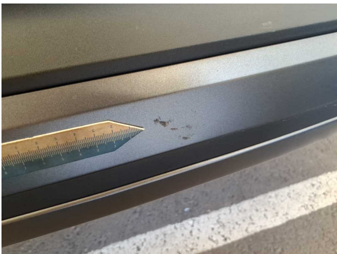
Damage 4: Rear bumper: Spoiler (Diffusor Stossfänger Hinten) - Scratch(es) - Replace
