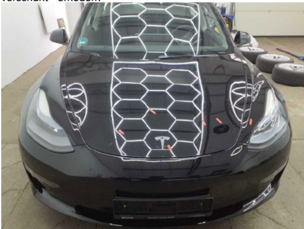
Beschädigung #8: Motorhaube: Motorhaube - Steinschlag - lackieren
