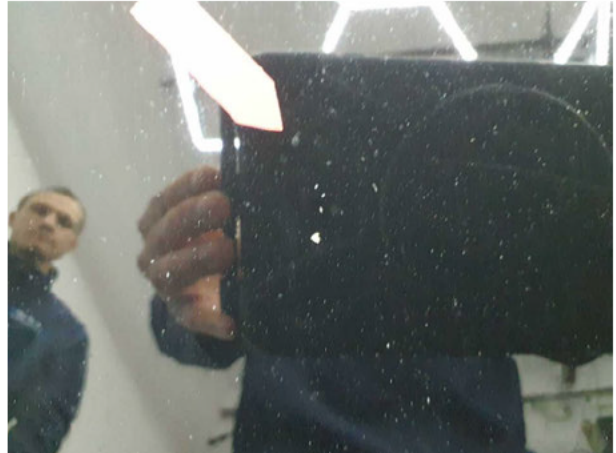
Beschädigung #8: Motorhaube: Motorhaube - Steinschlag - lackieren
