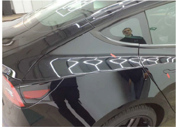
Beschädigung #4: Seitenwand rechts: Seitenwand (Vogelkot. Polieren) - auslegen / polieren
