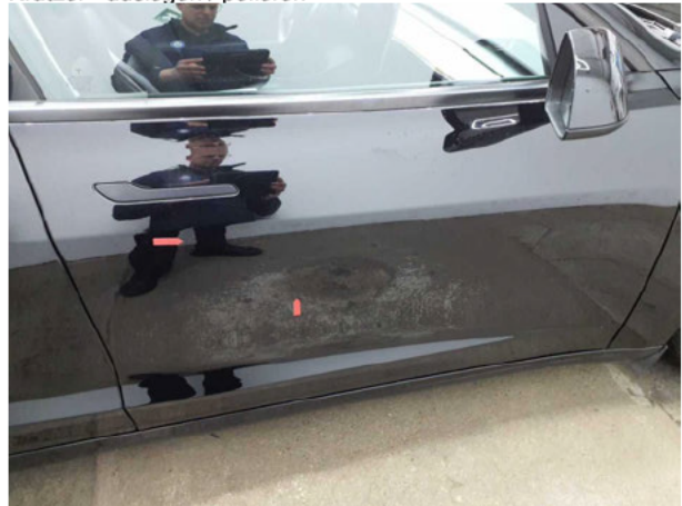
Beschädigung #6: Tür vorn rechts: Tür - Kratzer - auslegen / polieren
