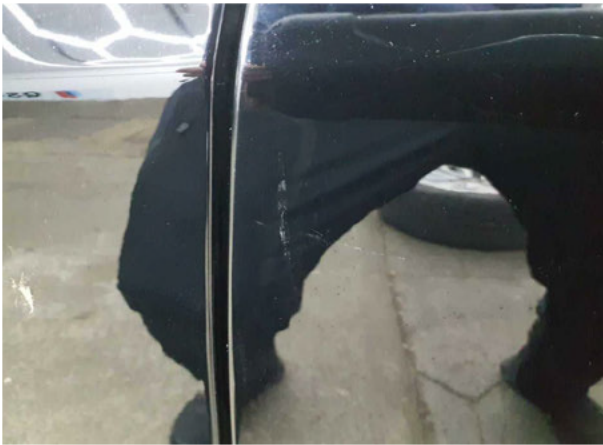
Beschädigung #9: Tür hinten links: Tür - Delle(n) - instandsetzen und lackieren
