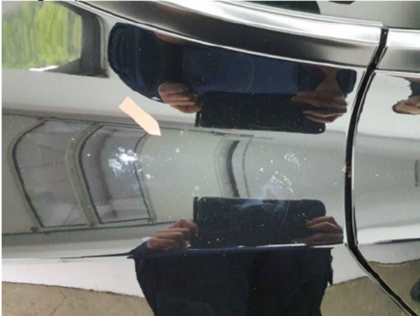
Beschädigung #4: Seitenwand rechts: Seitenwand (Vogelkot. Polier... - auslegen / polieren
