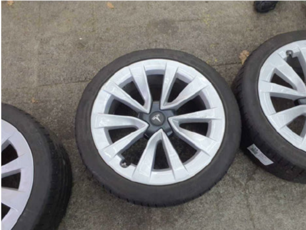
Beschädigung #7: 2.Radsatz: 1 Leichtmetallfelge - verkratzt / verschürft - erneuern
