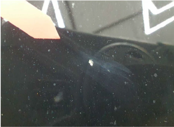
Beschädigung #8: Motorhaube: Motorhaube - Steinschlag - lackieren
