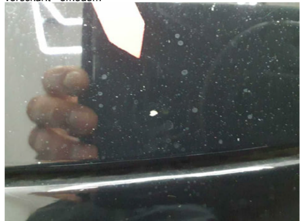
Beschädigung #8: Motorhaube: Motorhaube - Steinschlag - lackieren
