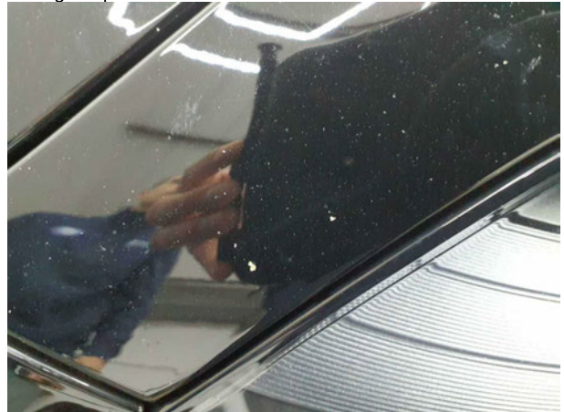
Beschädigung #2: Kotflügel links: Kotflügel links - Steinschlag - auslegen / polieren
