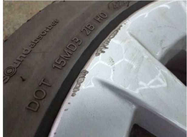
Beschädigung #7: 2.Radsatz: 1 Leichtmetallfelge - verkratzt / verschürft - erneuern
