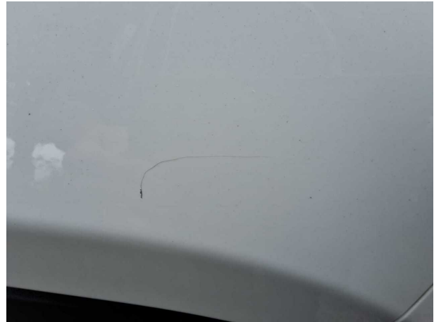
Beschädigung #1: Seitenwand links: Seitenwand - Kratzer - lackieren
