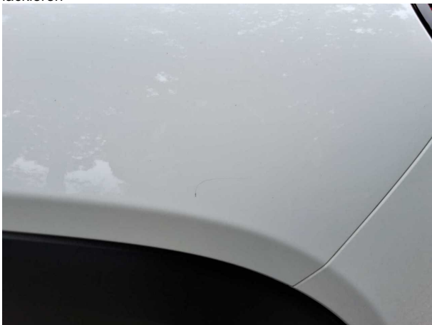
Beschädigung #1: Seitenwand links: Seitenwand - Kratzer - lackieren
