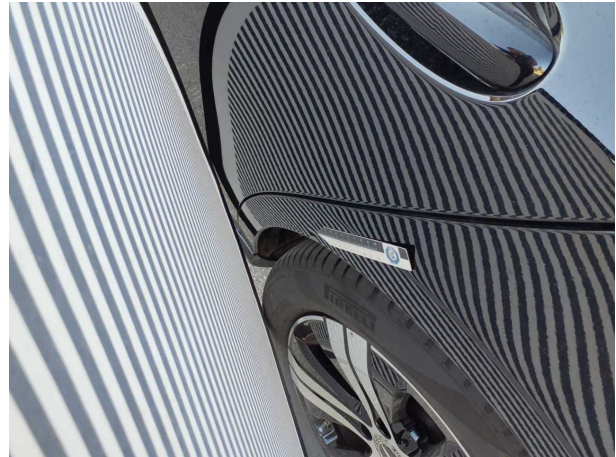
Beschädigung #1: Seitenwand links: Seitenwand - Delle(n) - sanft instandsetzen
