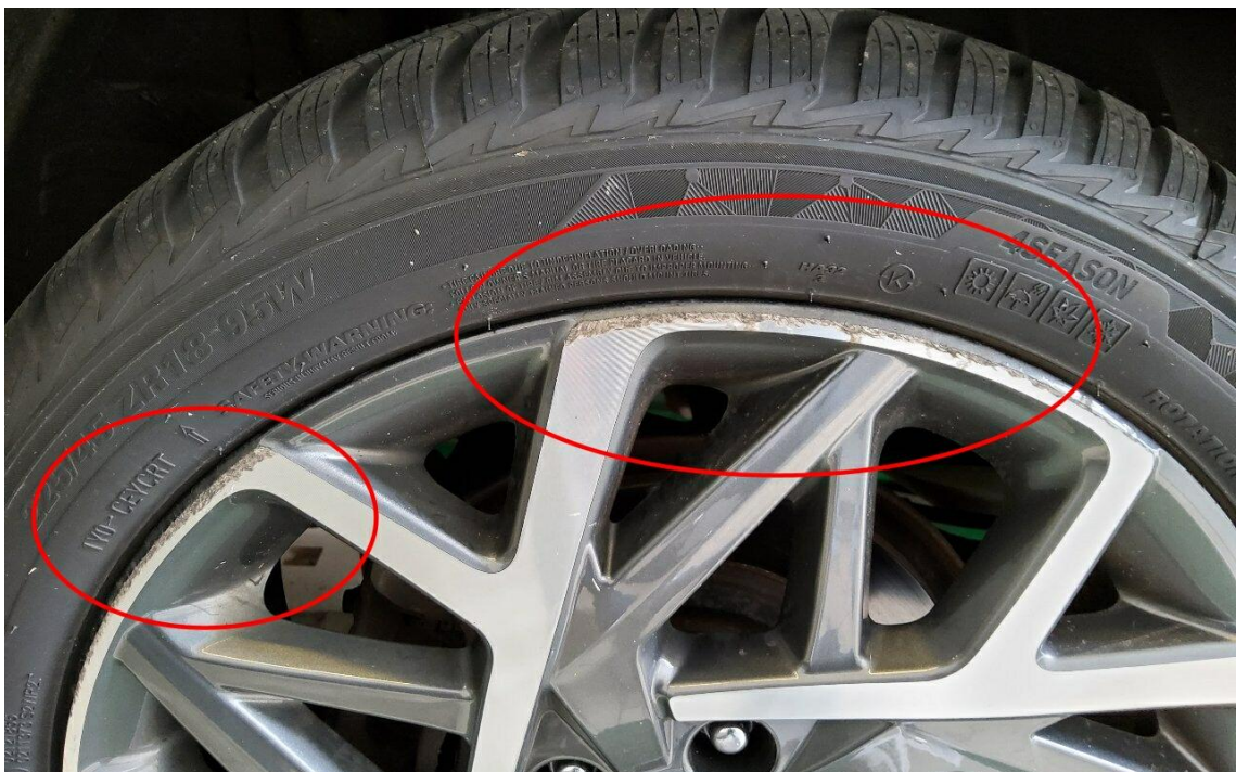
Bild 14 : Felge glanzgedreht hinten rechts mit Materialabtrag zerschrammt
