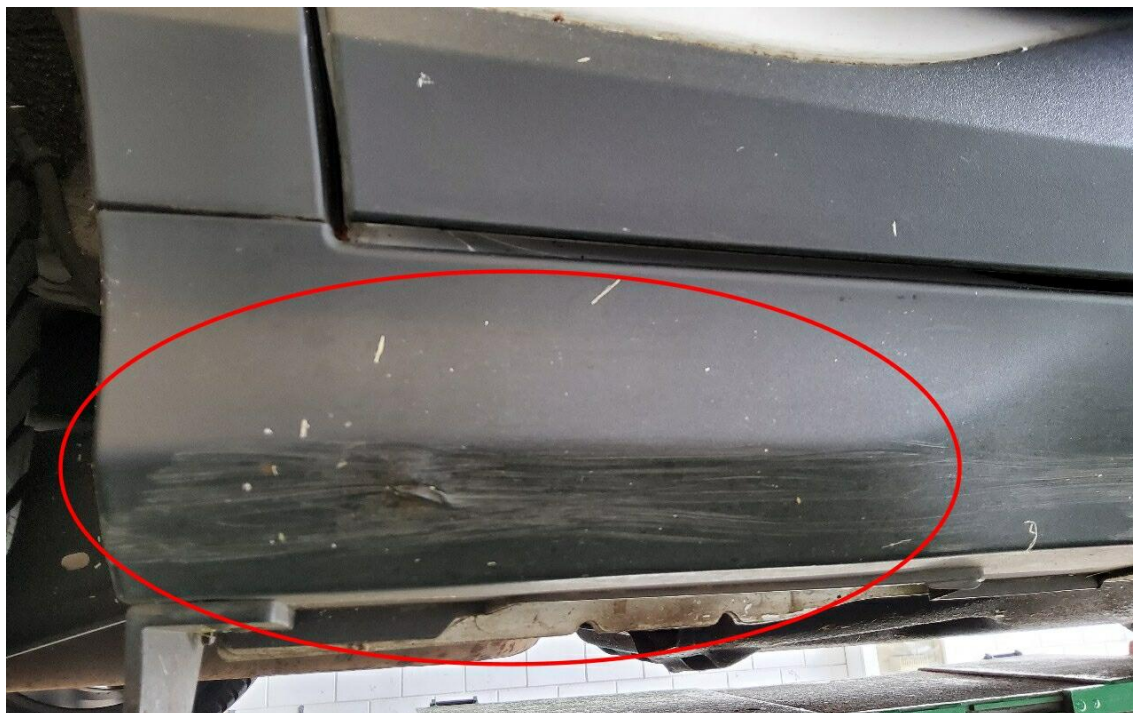
Bild 17 : Schwellerverkleidung rechts deformiert
