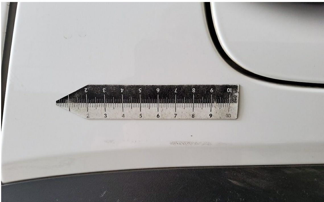
Bild 12 : Seitenteil hinten links Lackierung, verschrammt, polieren
