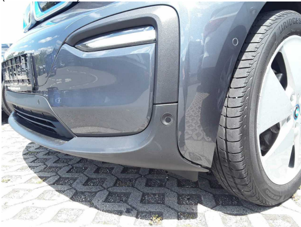
Beschädigung #1: Stossfänger vorn: Stossfänger vorn (Anfahrschaden) - verformt - erneuern
